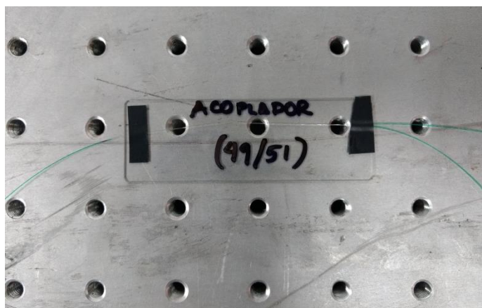
Figura 31. Acopladores fabricados con razón de acoplamiento (52/48, 50/50, 51/49) en el laboratorio de óptica fotónica.
