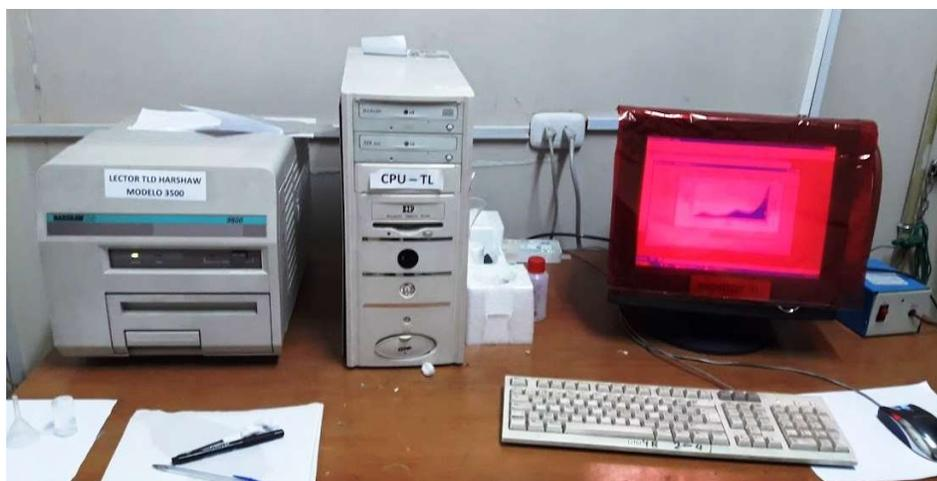
Figura 4.1: Equipo Thermo Scientific, Harshaw-3500 utilizado en el Laboratorio LaNMyD.
