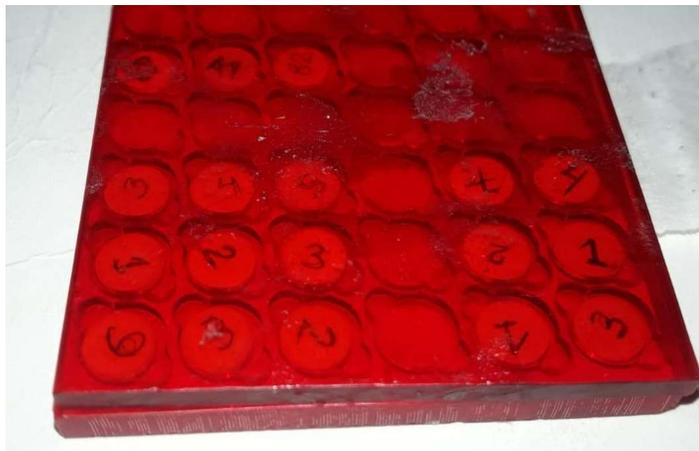
4.19. Pastillas de  $\text{CaSiO}_3$  dentro de capas acrílicas de 3 mm de espesor.
