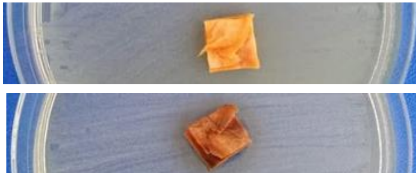
Figura 41. Prueba antimicrobial, cuero de paiche blanco (superior) y funcional (inferior), bacteria: E. coli .
