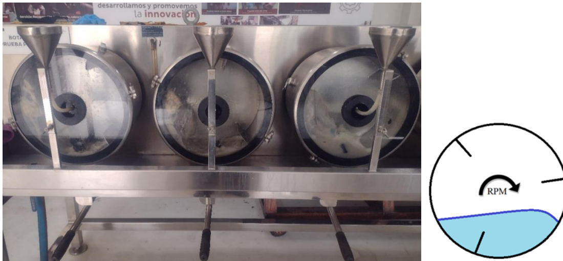
Figura 15. Izquierda: Botalitos de teñido (CITECCAL), Derecha: esquema
