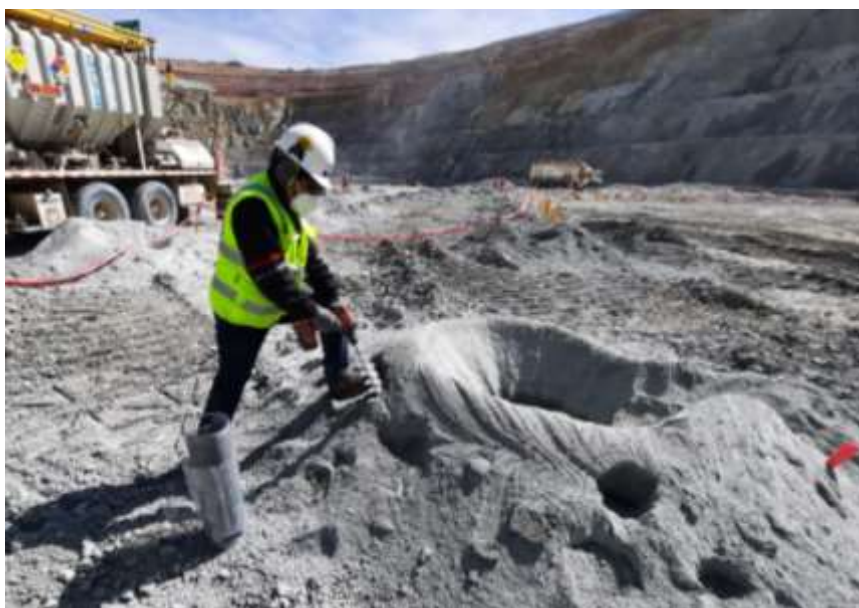
Figura 5.3. Muestreo de blasthole mediante inserciones con el Auger.
