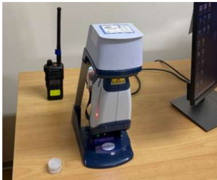
Figura 5.14. Lectura de muestras de blasthole con el equipo portátil de FRX.
