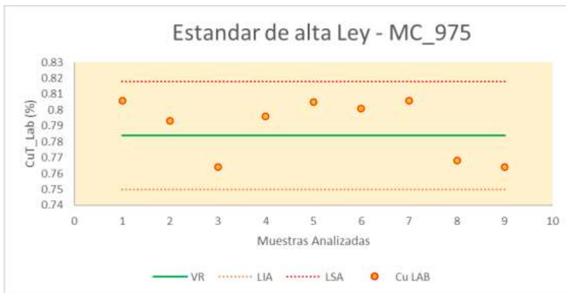
Figura 5.18. gráfico según el rango de aceptación para muestras estándar de alta ley.
