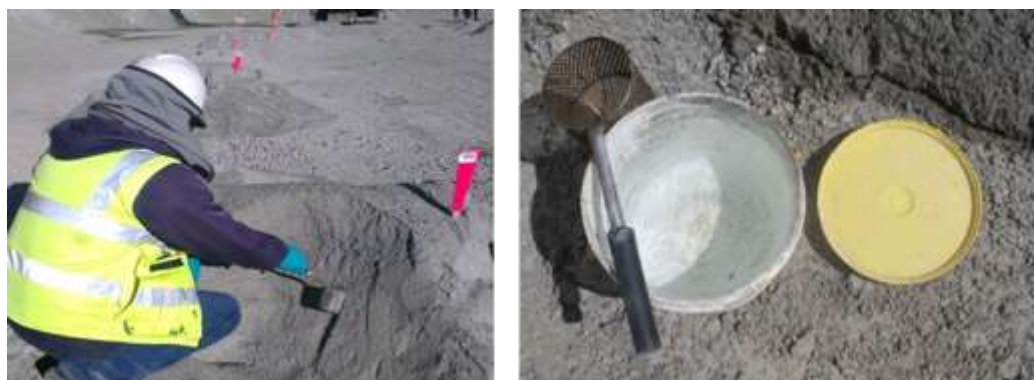
Figura 2.7. Proceso de logueo de blasthole.
