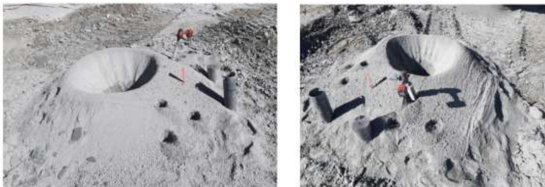
Figura 2.6. Muestreo sistemático de blasthole utilizando el Auger.
