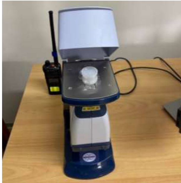
Figura 5.13. Muestra colocada correctamente en el equipo portátil de FRX.
