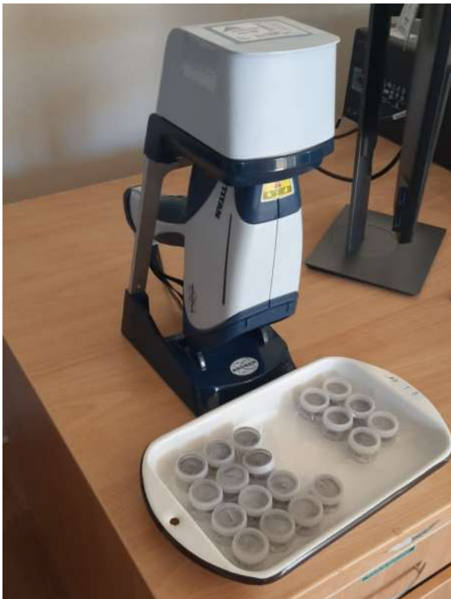
Figura 5.12. muestras preparadas y Equipo portátil de FRX.
