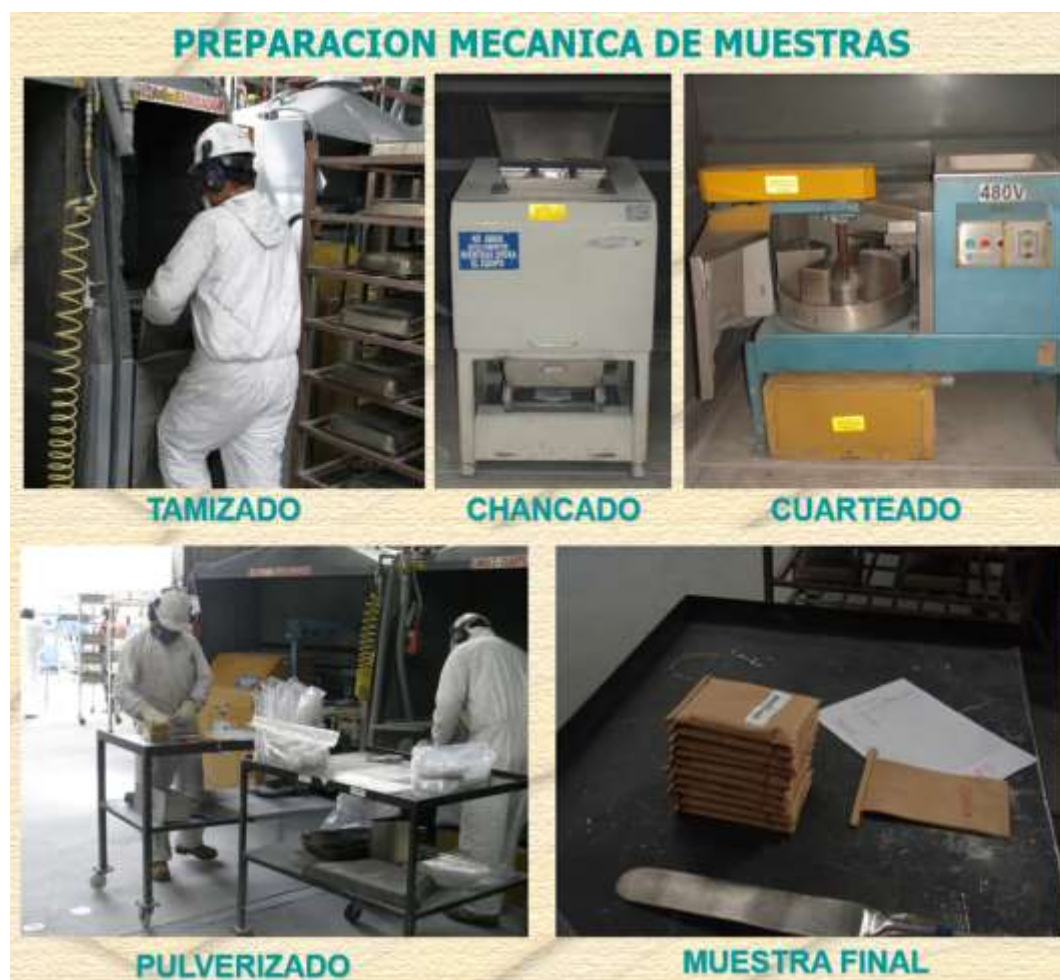
Figura 5.6. Secuencia del proceso de preparación de muestras
