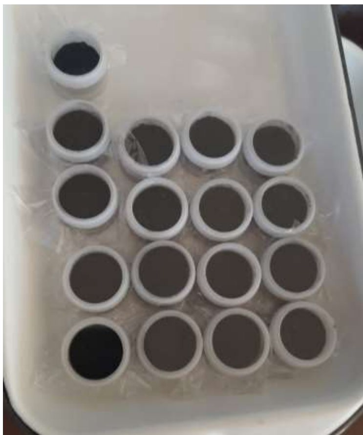
Figura 5.10. Muestras preparadas para lectura con FRX.
