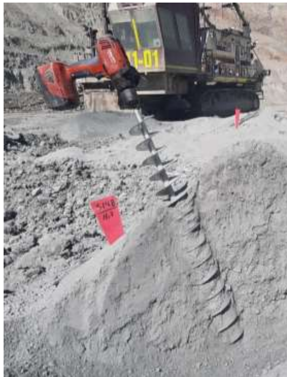
Figura 5.4. Corte del cono del blasthole luego de la inserción del Auger.
