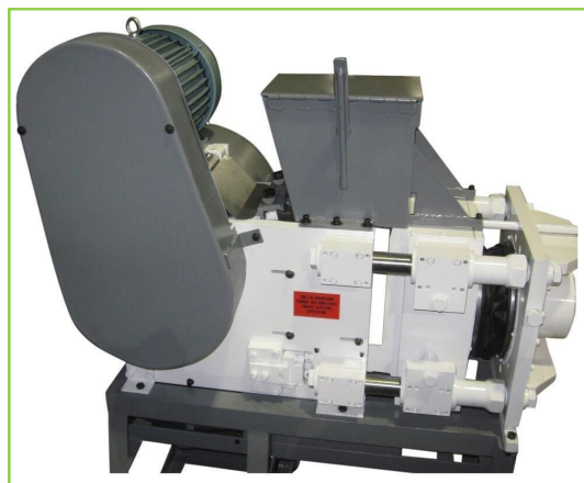
Figura 3.6 Chancadora de quijadas utilizada en laboratorio. Fuente: Elaboración propia
