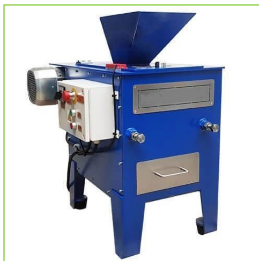
Figura 3.7 Chancadora de rodillos utilizada en laboratorio. Fuente: Elaboración propia
