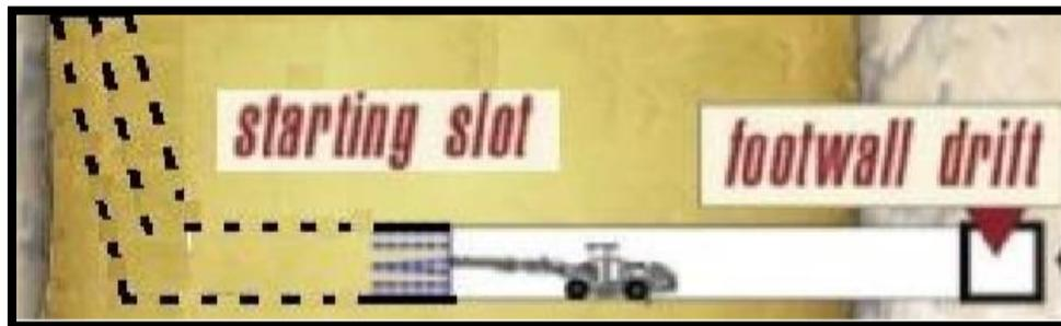
Figura 22 Perforación de Slot
