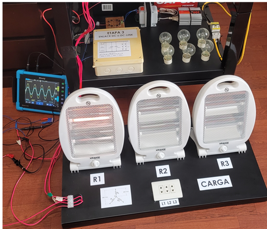
Figura 4.15 Funcionamiento del prototipo con una carga monofásica conectada (R1) de 350 vatios.
