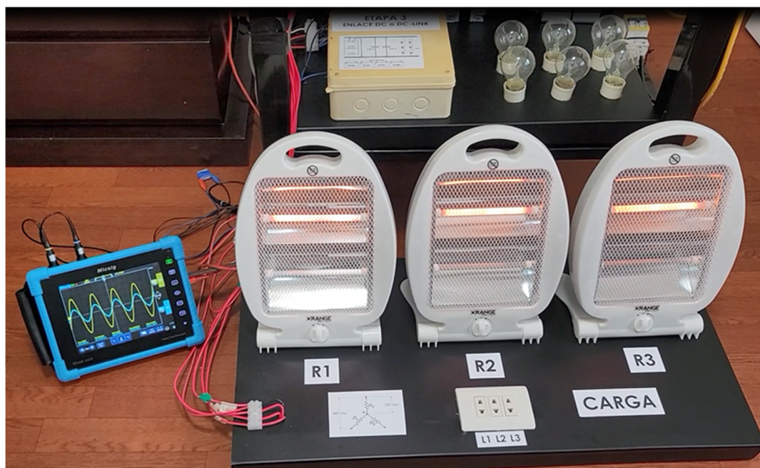
Figura 4.17 Funcionamiento del prototipo con una carga trifásica de 1050 vatios, las tres resistencias monofásicas conectadas (R1, R2 y R3).
