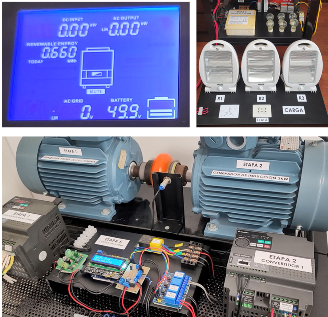
Figura 4.13 Arranque del prototipo del sistema convertidor de energía.
