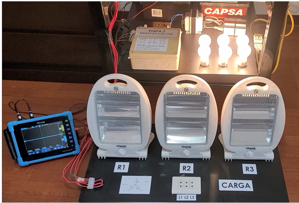
Figura 4.14 Segundos después del arranque el prototipo empieza a generar energía eléctrica a partir de la energía mecánica de la microturbina.
