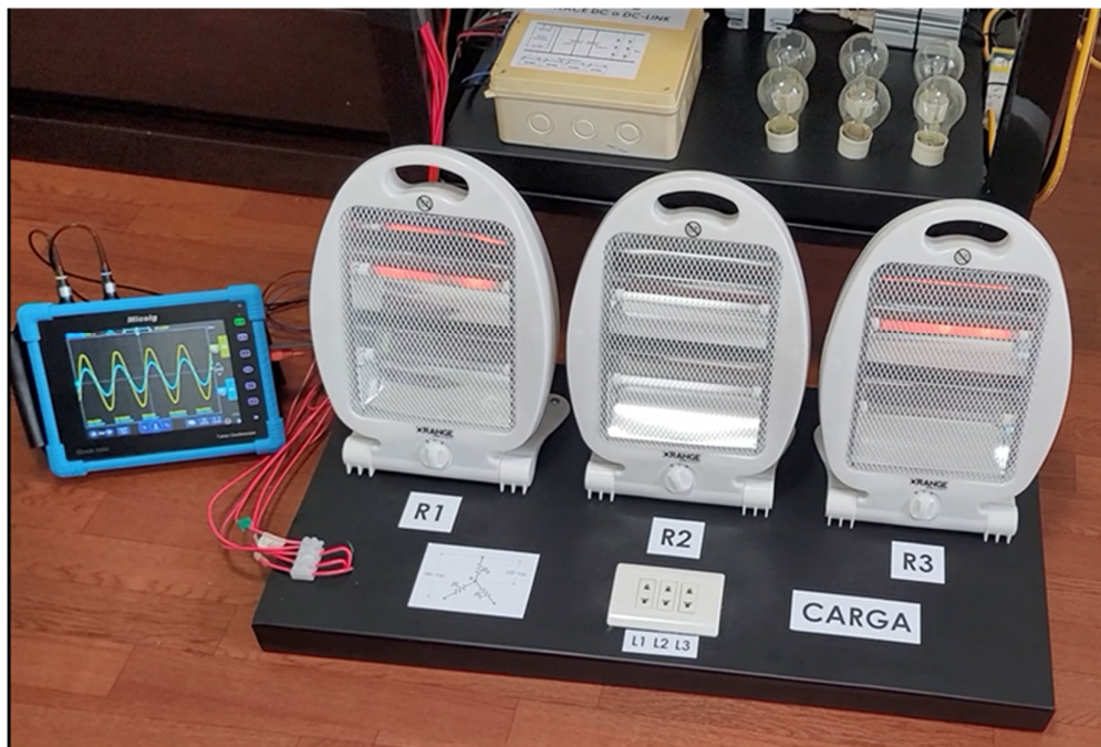
Figura 4.16 Funcionamiento del prototipo con dos cargas monofásica conectadas (R1 y R3) de 350 vatios cada una.
