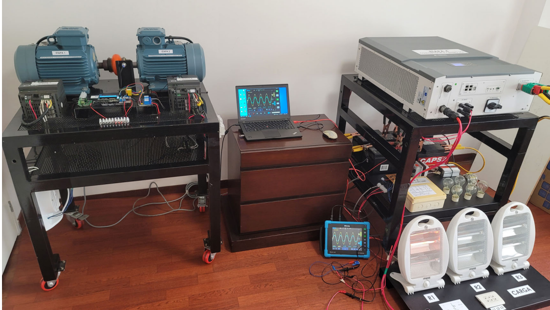
Figura 4.11 Prototipo del sistema convertidor de energía para micro-turbinas en fase de pruebas experimentales (carga R1 encendida).
