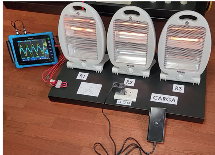
Figura 4.19 Forma de onda de la tensión (amarillo) y corriente (celeste) al conectar una pequeña carga no lineal en la línea 1 (cargador de celular).
