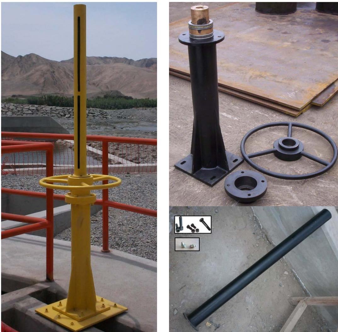
*Figura 3.2* Partes del mecanismo de izaje.
