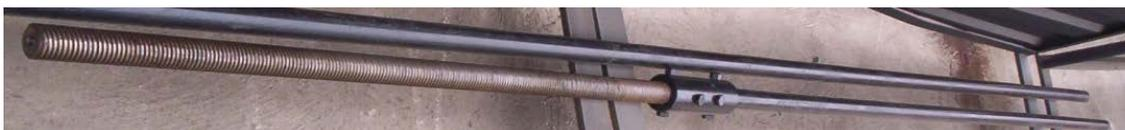
*Figura 3.3* Eje semi-roscado.
