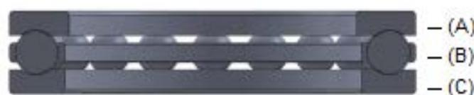
*Figura 4.5* Componentes del rodamiento axial de bolas: (A) Arandela de eje, (B) elementos rodantes y jaula, (C) arandela de alojamiento.
