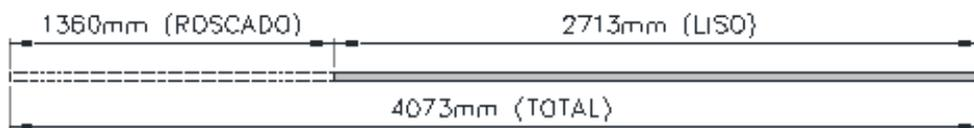
*Figura 4.2 Dimensiones generales del eje semi-rosado.*
