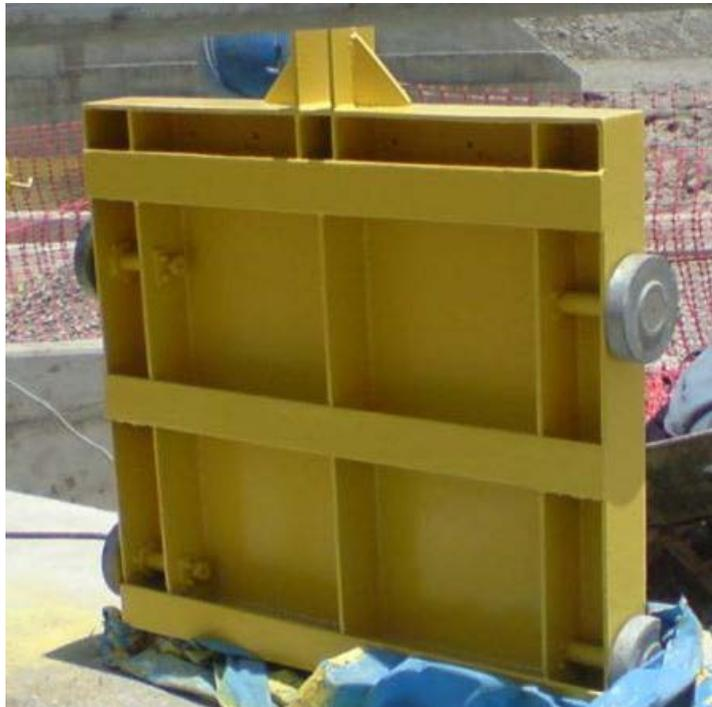
Figura 3.6 Compuerta deslizante de 0,9 m x 0,9 m.
