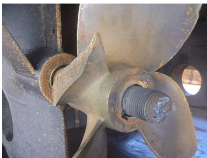
Imagen 2.11.2 Vista de hélice dañada por troncos encontrados por baja profundidad del río.
