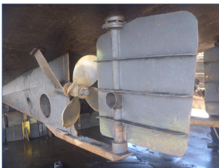
Imagen 2.11.1 Vista del sistema de propulsión convencional.
