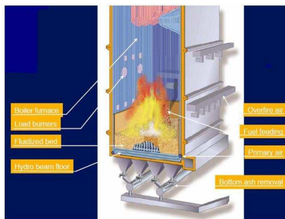
Figura 8: Un esquema de prototipo virtual con CCLF
