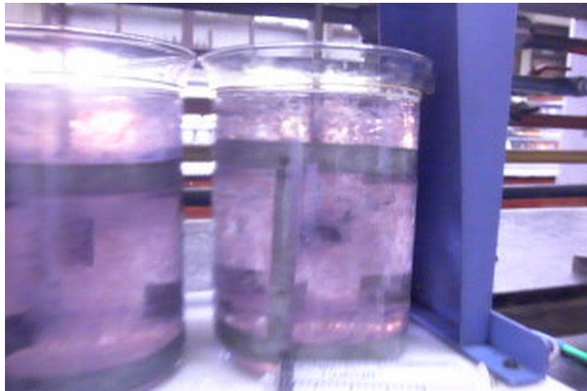
Figura 8.10. Presencia de floc formados y decoloración en la pruebas de jarras con sulfato de aluminio y poliacrilamida
