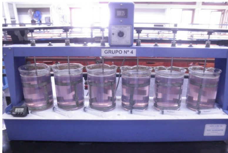
Figura 8.1. Equipo de multiagitación para pruebas de jarras
