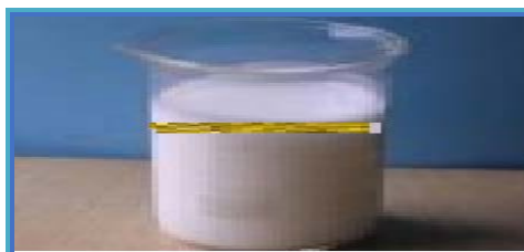
Figura N° 6.4: Coalescencia de aceite amarillo en emulsión
