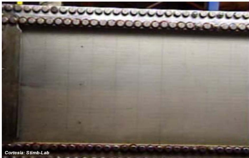
**Figura 7** Vista de perfil del equipo utilizado para el experimento de flujo de ranura (se aprecia el plano que simula la cara de la fractura)
