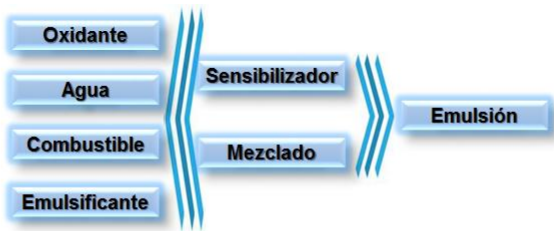
Figura 2,8 Composición típica de una emulsión Fuente: Agrega 2014
