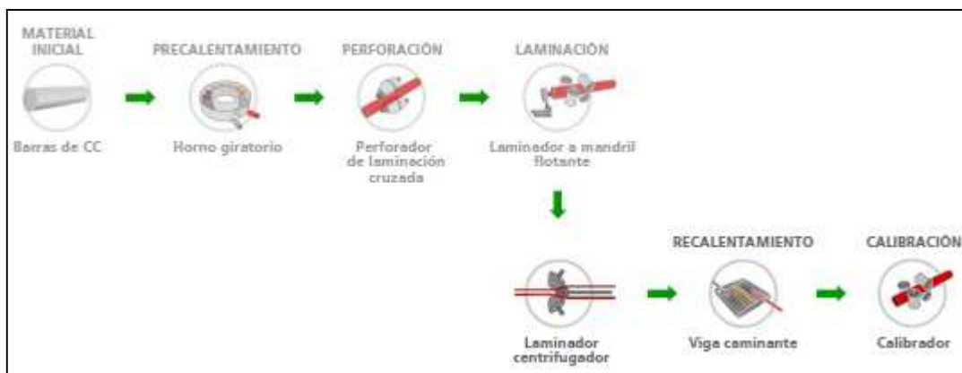
Figura 2 - 26. Esquema del proceso de laminación con laminador centrifugador
