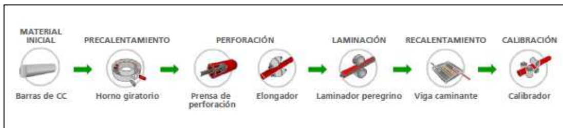
Figura 2 - 29. Esquema del proceso de laminación con laminador peregrino
