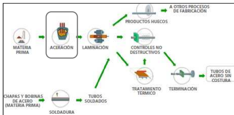
Figura 2 - 17. Esquema del proceso de producción de la tubería de perforación - Aceración
