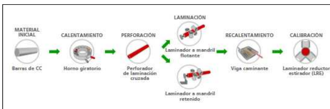
Figura 2 - 25. Esquema del proceso de laminación con laminador a mandril flotante
