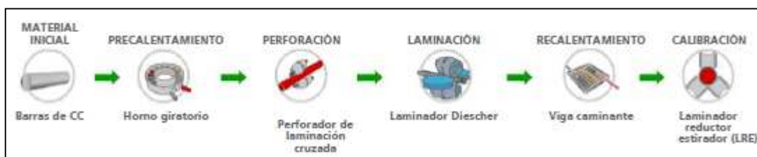
Figura 2 - 28. Esquema del proceso de laminación con laminador Diescher
