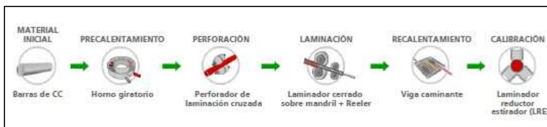
Figura 2 - 27. Esquema del proceso de laminación con laminador cerrado sobre mandril
