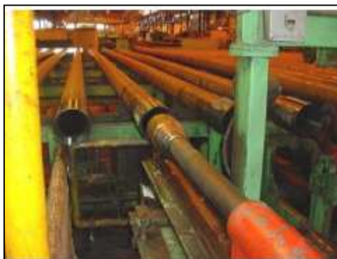
Figura 2 - 41. Calibrador del tubo con conexión
