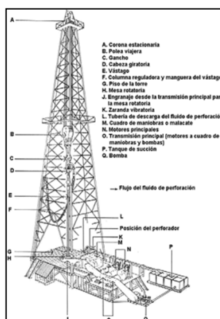
Figura 2 - 2. Torre de perforación
