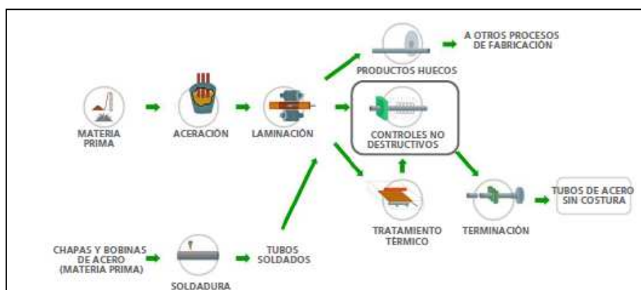
Figura 2 - 35. Esquema del proceso de producción de la tubería de perforación – Controles no destructivos
