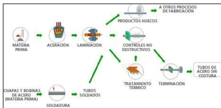
Figura 2 - 10. Esquema del proceso de producción de la tubería de perforación
