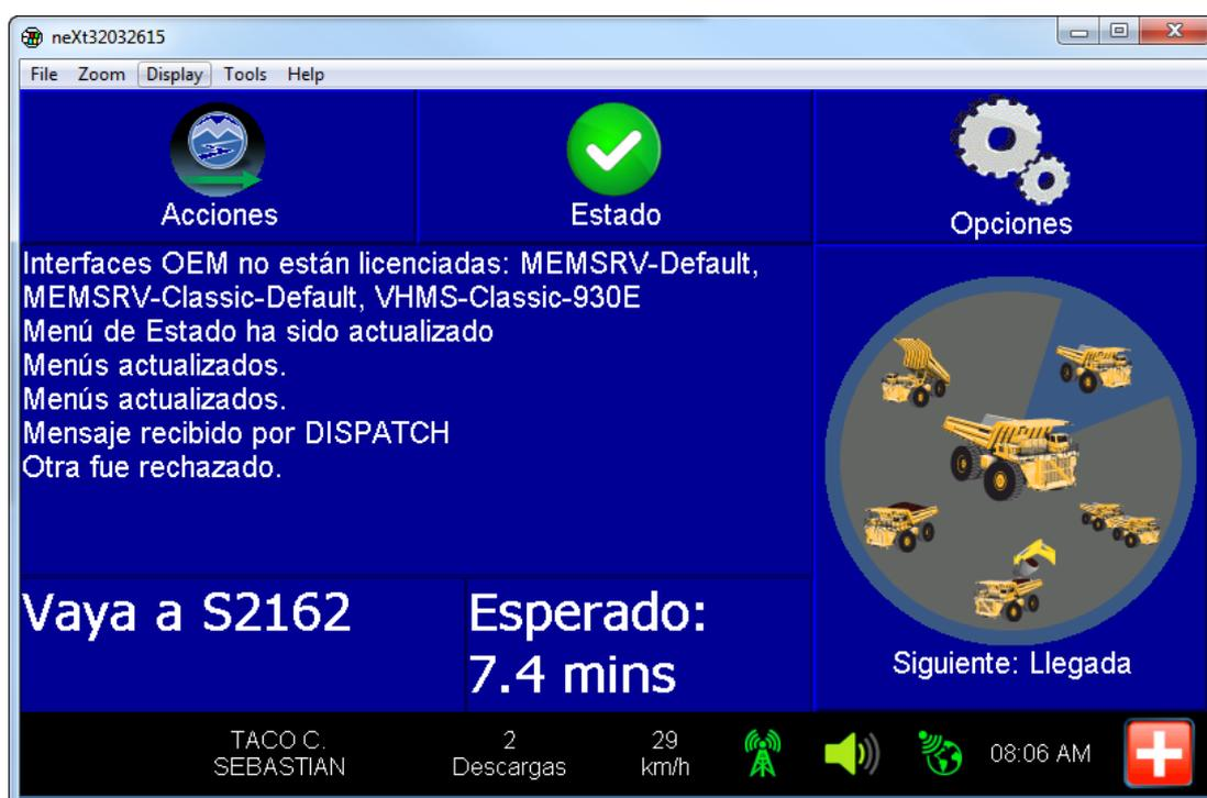
Figura 1.6 PTX de 7" Pantalla de Camión
