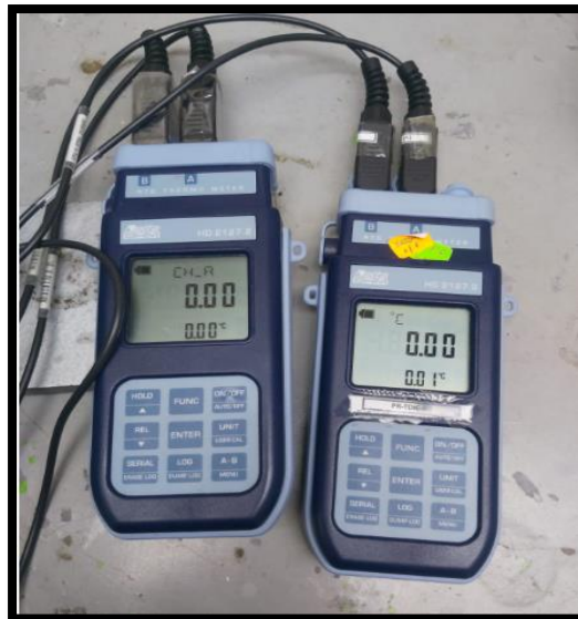
Fig 17: Termómetro de resistencia de platino ( foto propia)
