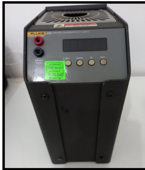
Fig. 9: Pozos secos (foto propia)
