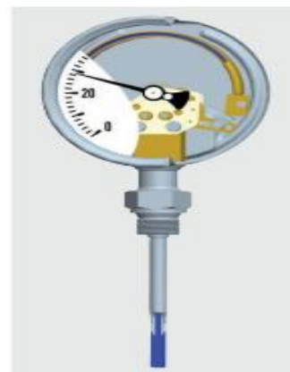
Fig. 4 Ejemplo del termómetro tipo de dilatación de gas [5]
