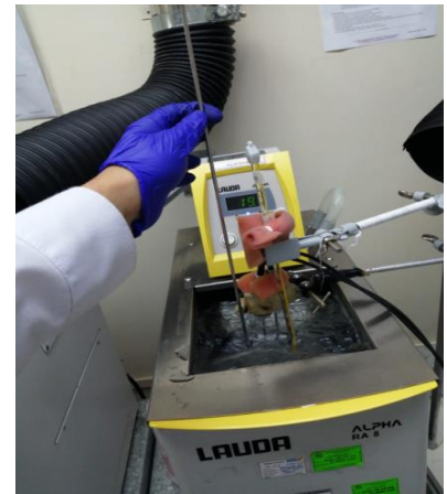
Fig 18 Baño termostático de agua (foto propia)
