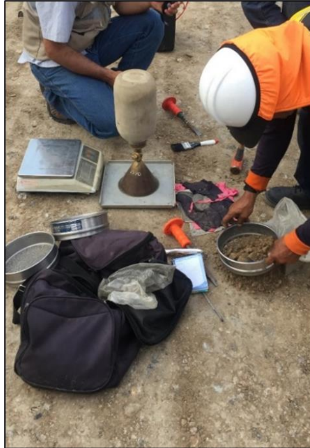
Figura 4.1.6.2. Ensayo de densidad de campo. Fuente: Elaboración propia.
