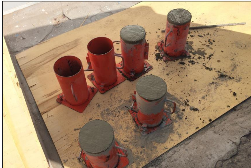
Figura N° IV.7 Control de elaboración de probetas en obra.
