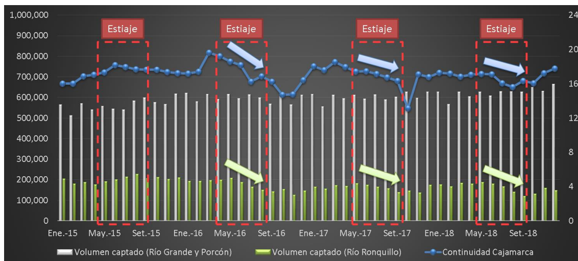
Imagen N° 4: Comparación de la evolución de continuidad promedio, volúmenes captados y temporadas de estiaje (2015 – 2018). Generado de la información adicional remitida en el Plan Maestro Optimizado de SEDACAJ S.A. para el periodo 2019 – 2049. (SEDACAJ S.A., 2019)
