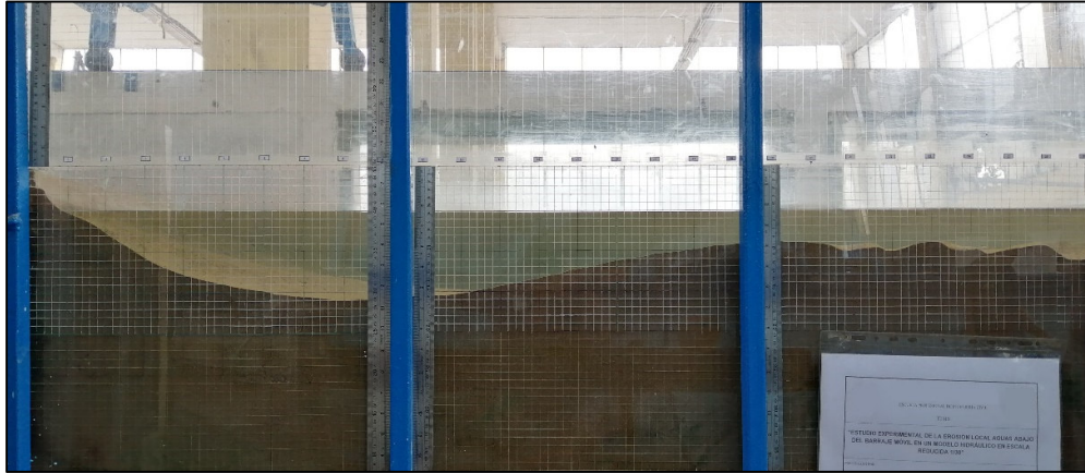
Figura B.7. Erosión en la ventana de visualización.
