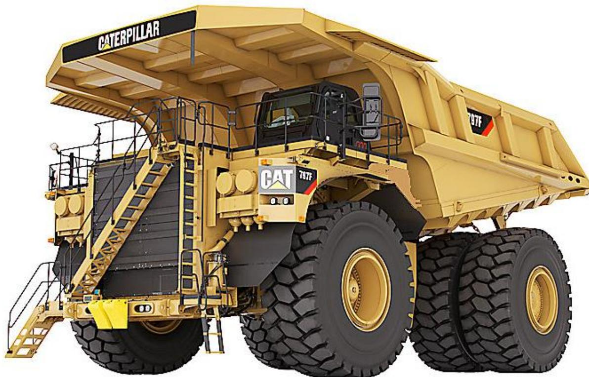
**Figura 2.1** Camión minero marca Caterpillar modelo 797F
