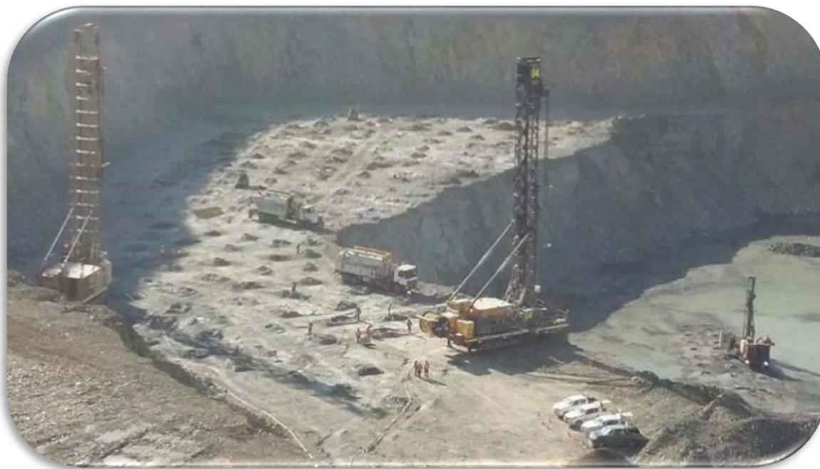
**Figura 2.6** Perforadora Eléctrica Marca P&H Modelo 320 XPC Utilizado en las BAMBAS
