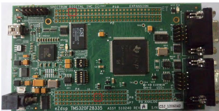
**Figura 6.7:** Pines del Protocolo SPI del eZdsp F28335.
