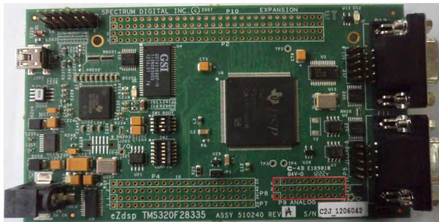
**Figura 6.6:** Canales ADC del eZdsp F28335.
