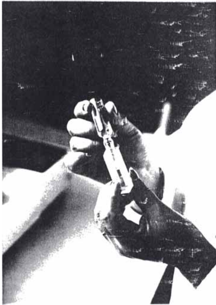
FOTO Nº5 VERTIDO DE LA SOLUCION DOSIMETRICA IRRADIADA EN LAS CELDAS PARA LA LECTURA DE LA ABSORBANCIA
