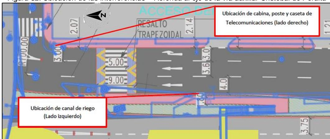
Figura 53: Tapas de canal de riego que invaden la calzada
