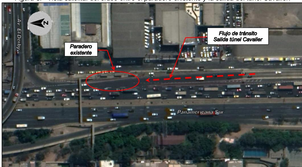
Figura 4: Vista del paradero existente que intercepta la salida del túnel Cavalier.
