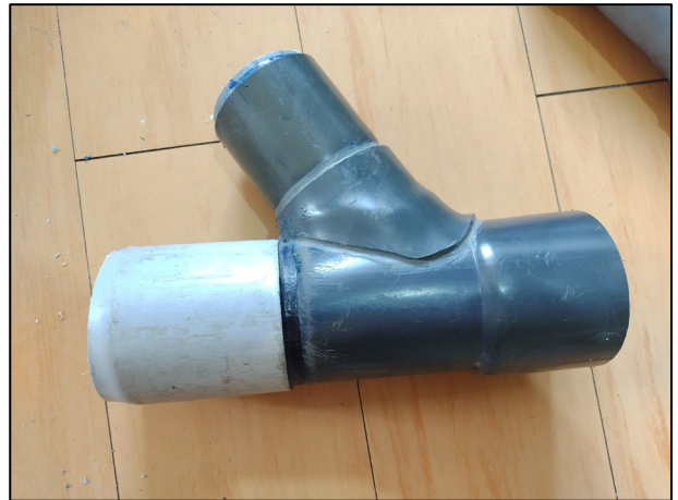
5. Yee de \text{Ø}2 " con \text{Ø}2 " y de \text{Ø}3 " con \text{Ø}2 "
