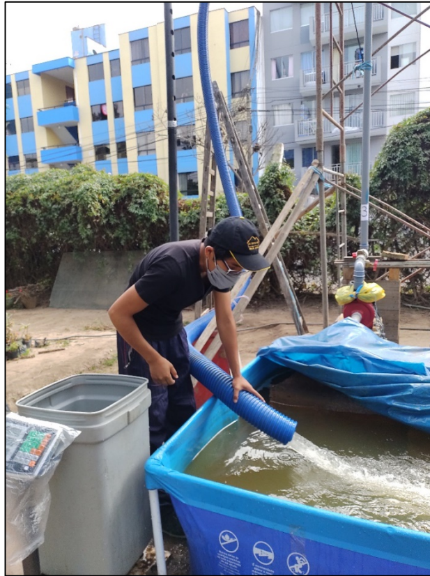
Figura 4.26 Lectura de caudal general del sistema sifónico
