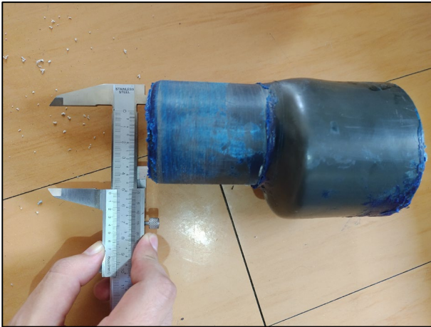
7. Reducción de \text{Ø}2\frac{1}{2} " a \text{Ø}2 "
