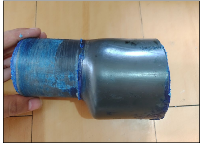
7. Reducción de \text{Ø}2\frac{1}{2} " a \text{Ø}2 "
