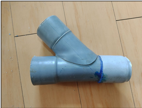
5. Yee de \text{Ø}2 " con \text{Ø}2 " y de \text{Ø}3 " con \text{Ø}2 "
