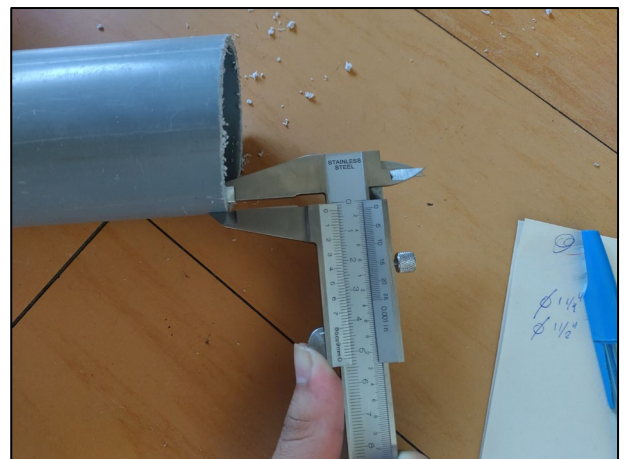
3. Tubería de PVC de \text{Ø}2 " con diámetro interno de 54.2 mm y 2.9 mm de espesor
