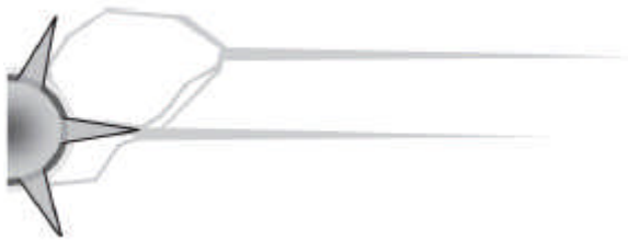
Figura 7.5-2 Diagramática ilustración de los Patrones de Flujo restringido entre las Perforaciones y la Fractura(s) Principal que causan tortuosidad.
