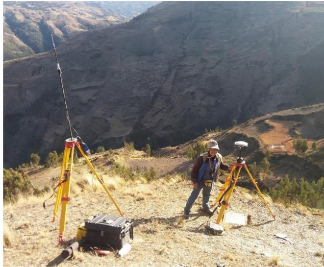
Fotografía N°1 Equipo geodésico instalado, se observa receptor GNSS “spectra precisión”, radio, antena de largo alcance, batería externa y panel solar
