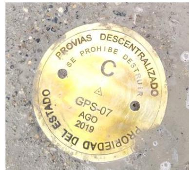
Fotografía N°38 Fabricación de punto geodésico GPS 07 (Cajabamba – Cajamarca)
