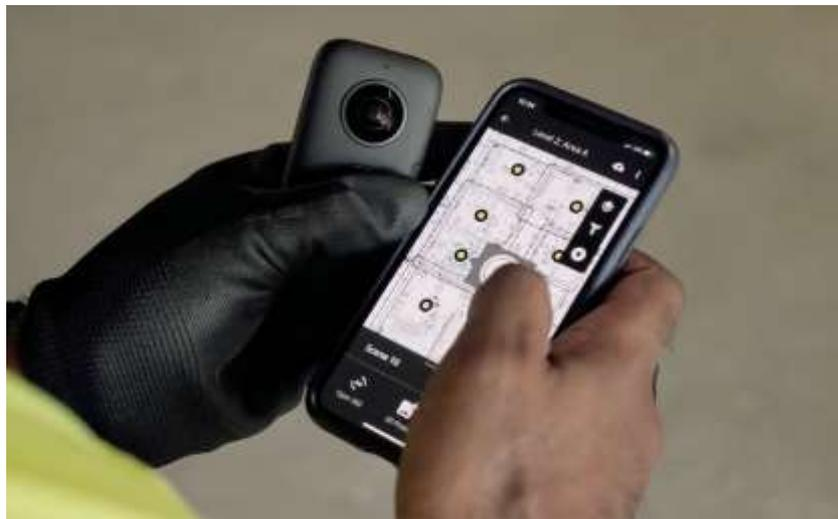
Figura N° 27 Sincronización del App de HoloBuilder con un dispositivo Smart
