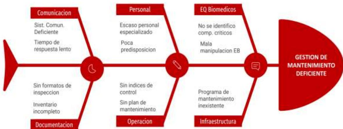
Figura N° 21 Diagrama causa-efecto de la Gestión de Mantenimiento Deficiente
