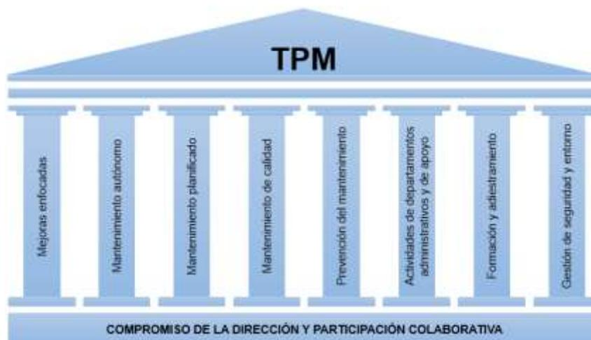
Figura N° 5 Pilares del Mantenimiento Productivo Total (TPM)
