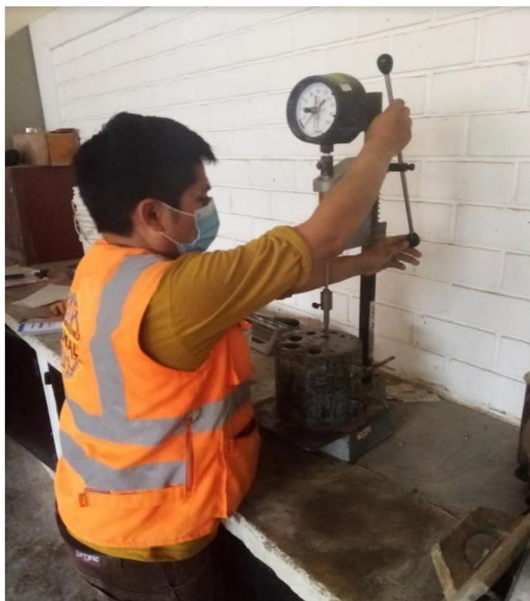
Figura N°10: Ensayo de tiempo de fragua mediante las agujas de Vicat para cada diseño de concreto (capitulo 5.1.6)
