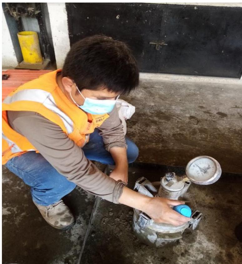
Figura N°08: Ensayo de contenido de aire mediante la olla de Washington para cada diseño de concreto (capítulo 5.1.4)
