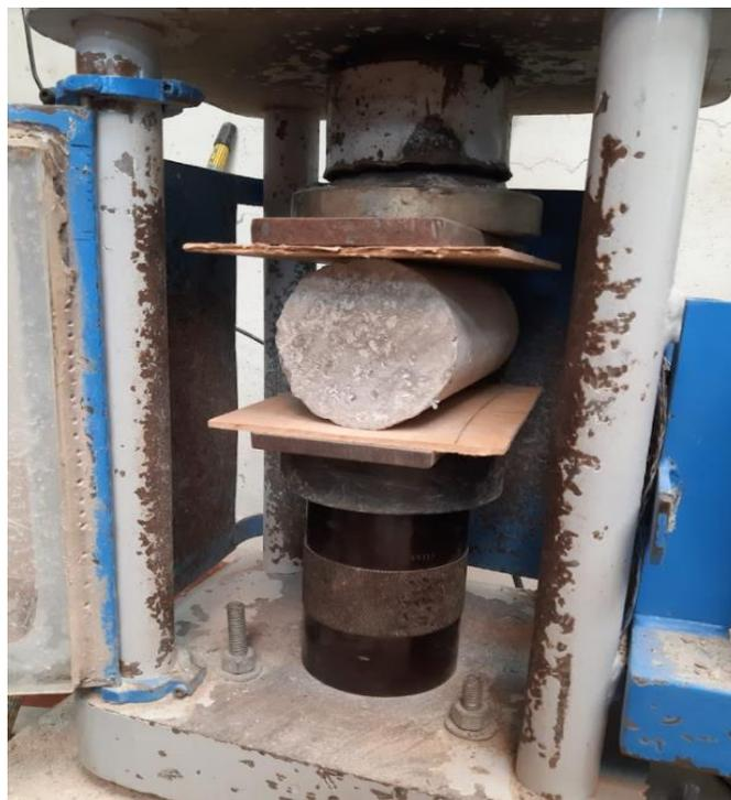
Figura N°12: Ensayos de resistencia a la tracción diametral para cada diseño de concreto
