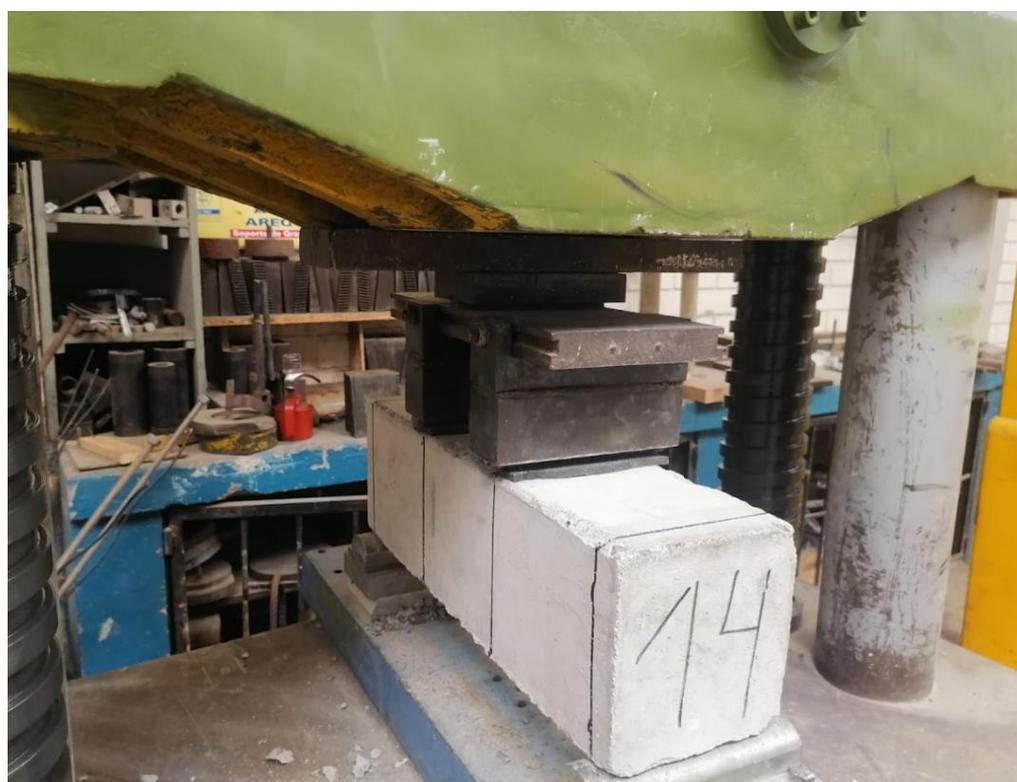
Figura N°14: Ensayo de resistencia a la flexión de vigas a los 28 días para cada diseño de concreto (capitulo 5.2.4)
