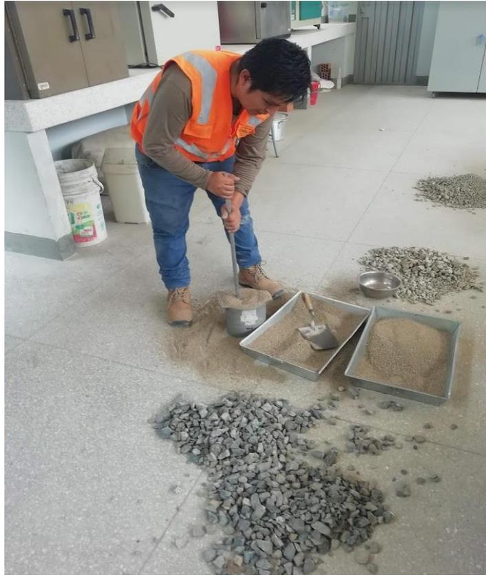
Figura N°03: Ensayos de peso unitario suelto y compactado del agregado fino (tabla N°5)
