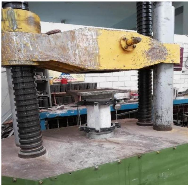
Figura N°13: Ensayo de M.E. mediante la máquina universal para cada diseño de concreto (capitulo 5.2.4)
