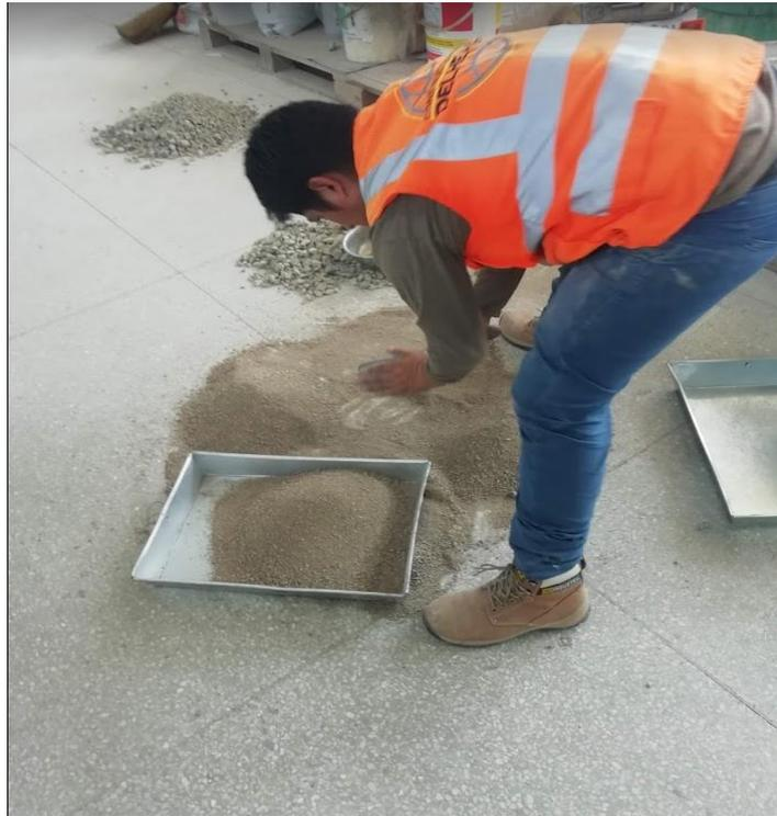
Figura N°01: Cuarteo para ensayos y obtener propiedades del agregado fino (capítulo 3.2)
