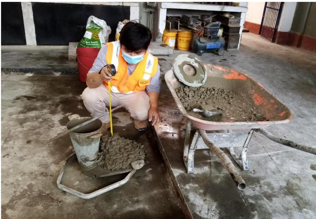
Figura N°05: Obtención del asentamiento mediante el cono de Abrams de cada muestra preparada (capítulo 5.1.1)
