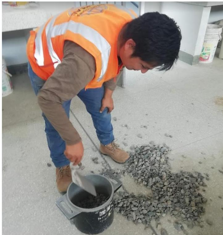
Figura N°02: Cuarteo para ensayos y obtener propiedades del agregado grueso (capítulo 3.2)
