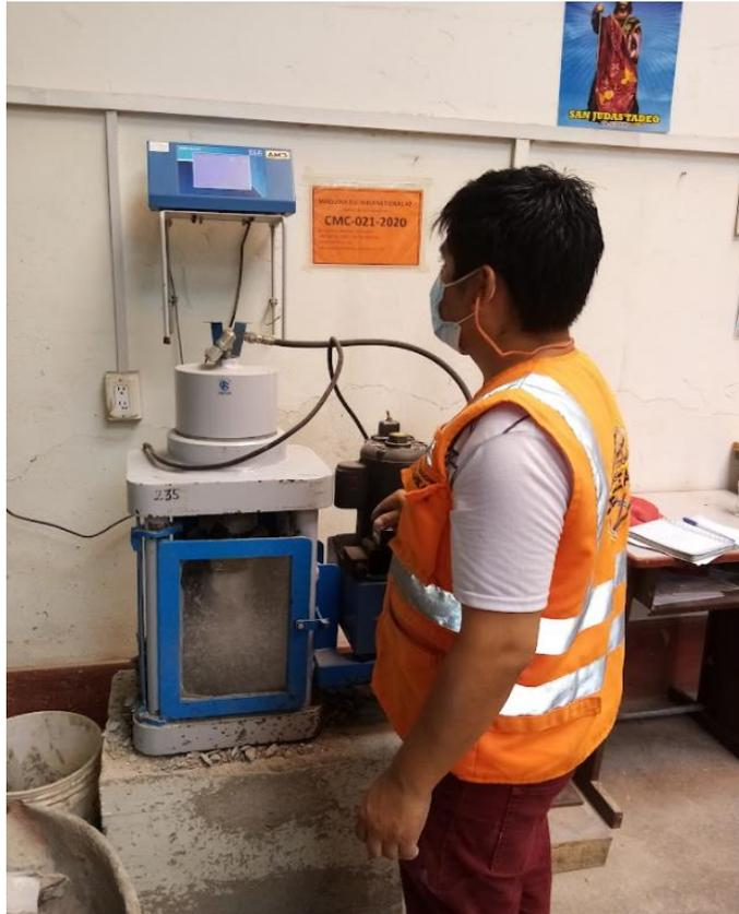
Figura N°11: Ensayos de resistencia a la compresión axial para cada diseño de concreto
