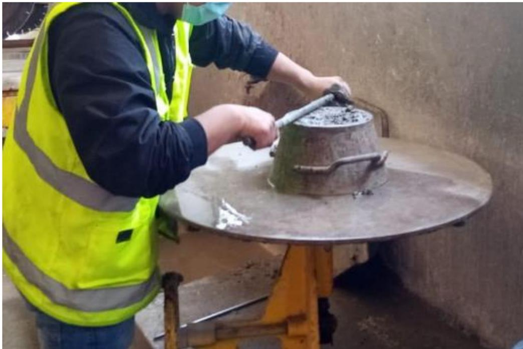
Figura N°07: Ensayo de fluidez en la mesa de sacudidas para cada diseño de concreto (capítulo 5.1.3)
