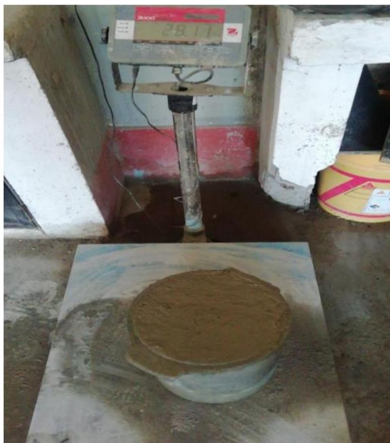
Figura N°06: Ensayo de peso unitario de todas las muestras de concreto (capítulo 5.1.2)
