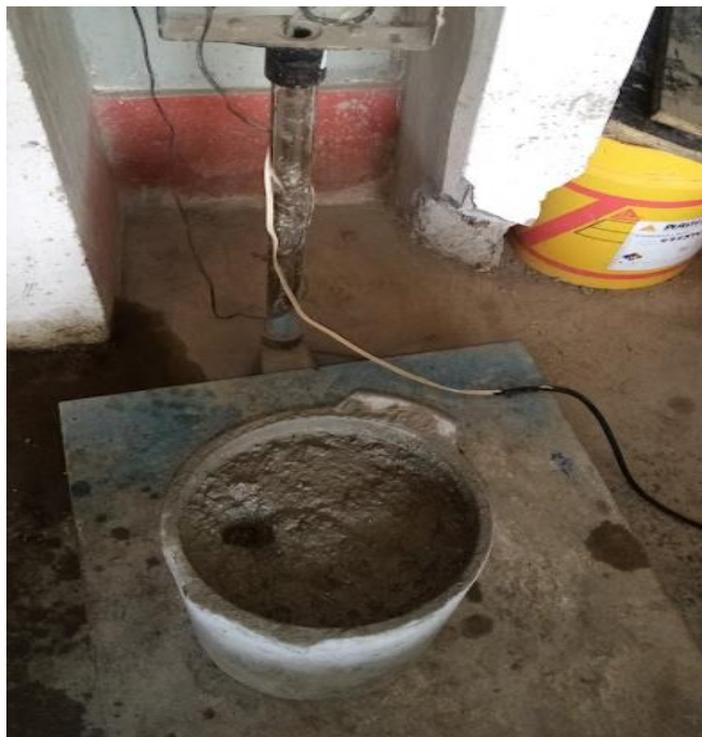
Figura N°09: Ensayo Exudación para cada diseño de concreto (capitulo 5.1.5)
