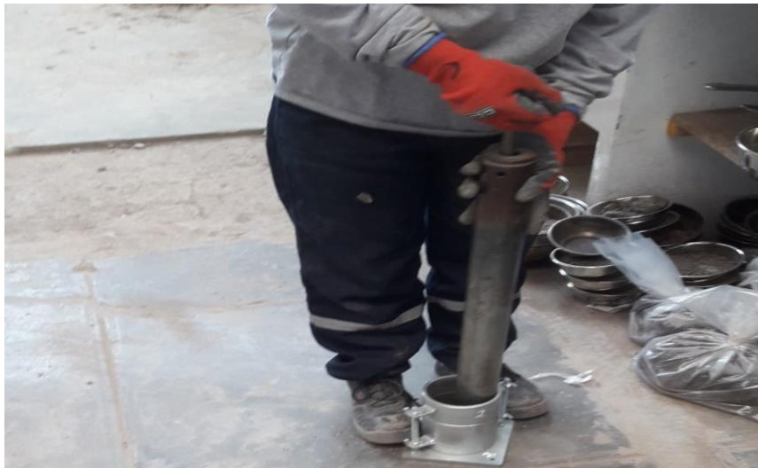
Figura 55 aplicación de 25 golpes con un pistón la primera capa de la muestra
