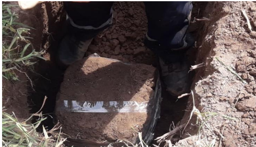
Figura 45 Muestra de arcilla recolectada para ensayos de laboratorio
