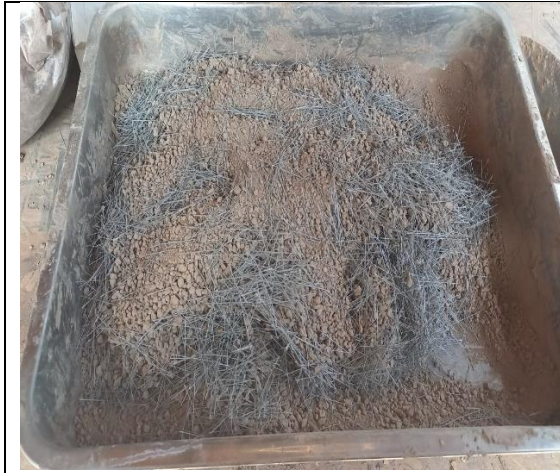
Figura 24 Suelo natural reforzado con 1.5% de fibras sintéticas recicladas de 3cm
