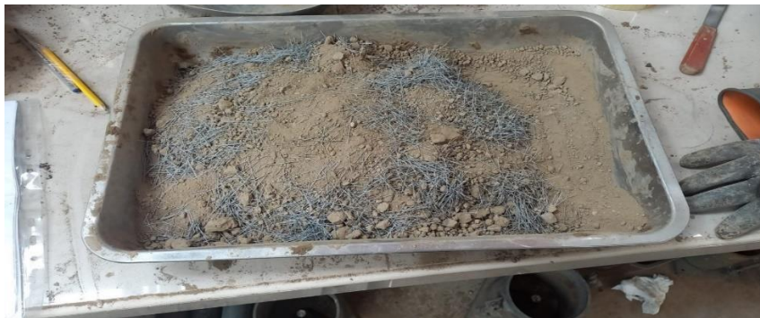
Figura 76 Suelo patrón con 1% fibras sintéticas 3cm de longitud para ensayo CBR
