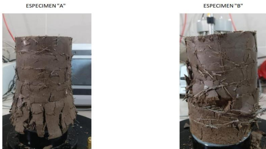
Figura 70 rotura de probeta A y B muestra con 0.5% fibras sintéticas de 6cm
