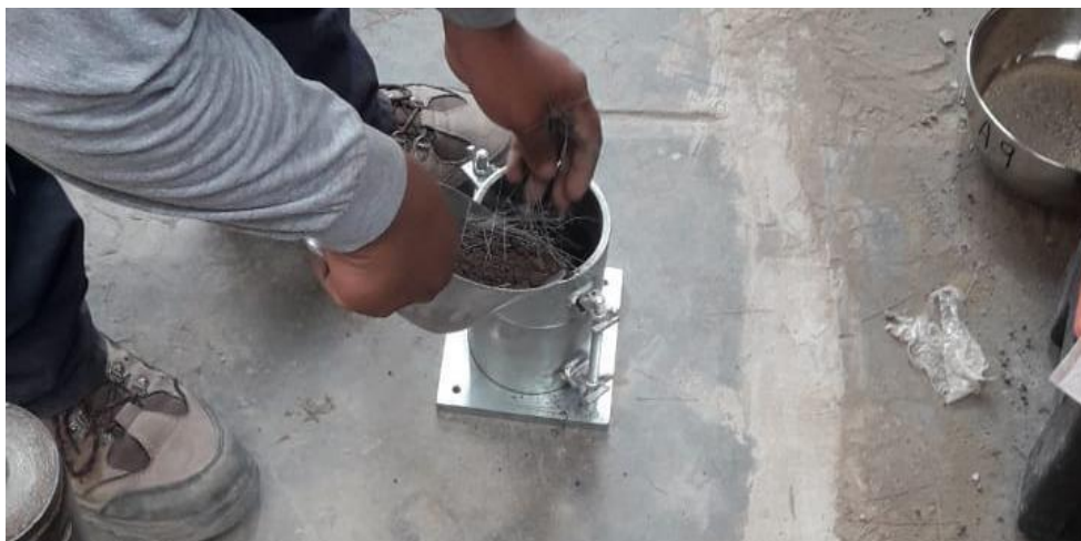
Figura 62 Colocación de la primera capa de la muestra con 0.5% fibras de Longitud 6 cm en el molde
