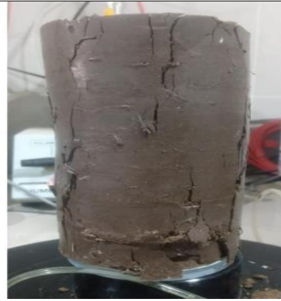
Figura 19 Rotura de probeta suelo natural reforzado con 1% de fibras sintéticas recicladas de 3cm
