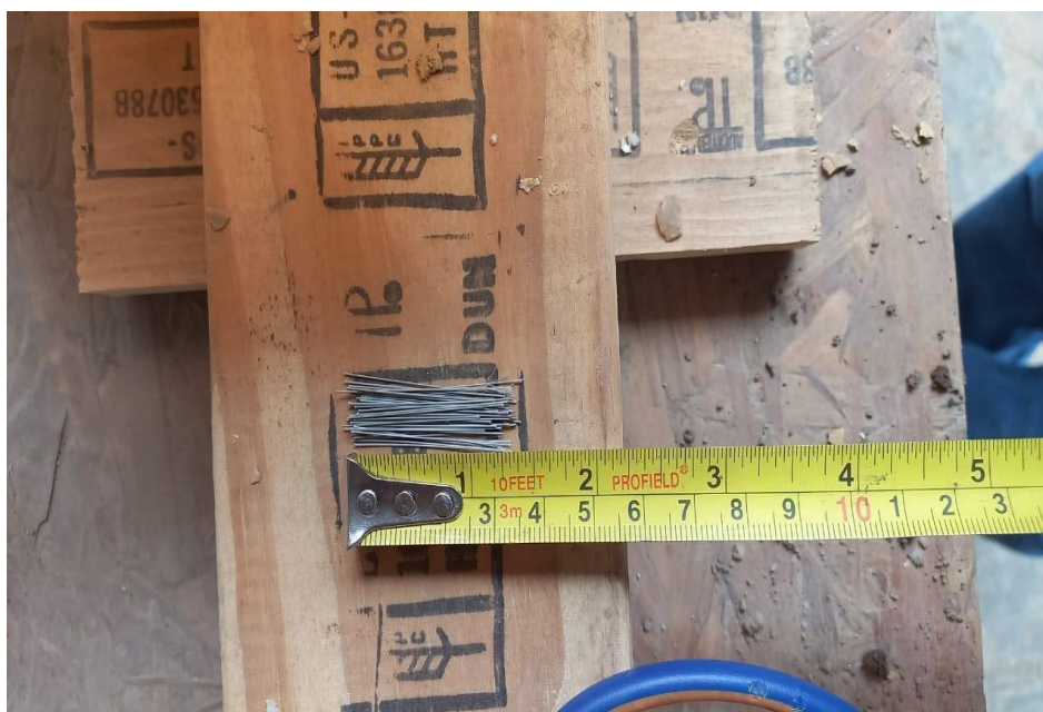
Figura 47 Fibras sintéticas recicladas (PET) de 3cm de longitud
