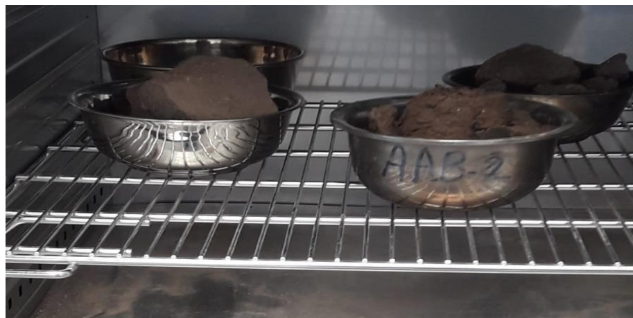
Figura 60 Colocación de muestra en el horno para luego determinar la humedad
