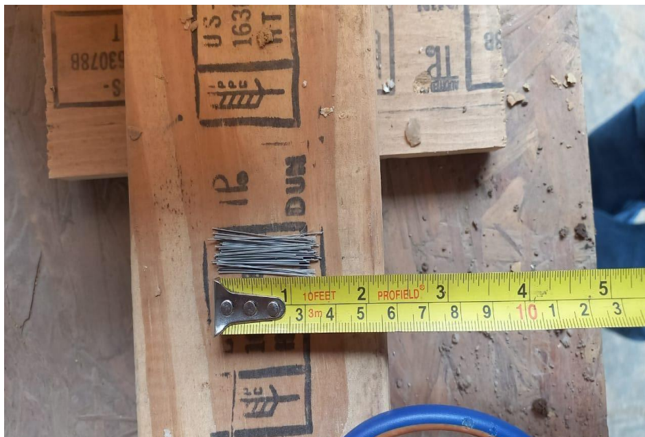
Figura 14 Fibras sintéticas recicladas de 3cm
