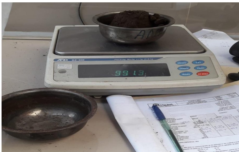
Figura 59 Peso de la muestra húmeda más la tara
