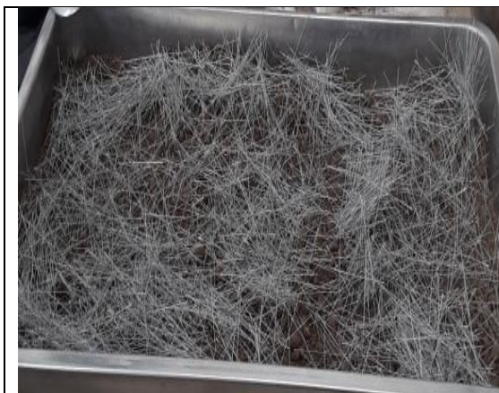
Figura 22 Suelo natural reforzado con 1.5% de fibras sintéticas recicladas de 6cm
