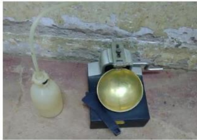
Figura 49 Equipo empleado en el ensayo límite líquido
