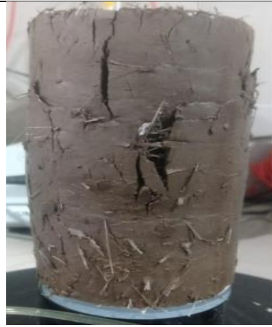
Figura 25 Rotura de probeta suelo natural reforzado con 1.5% de fibras sintéticas recicladas de 3cm
