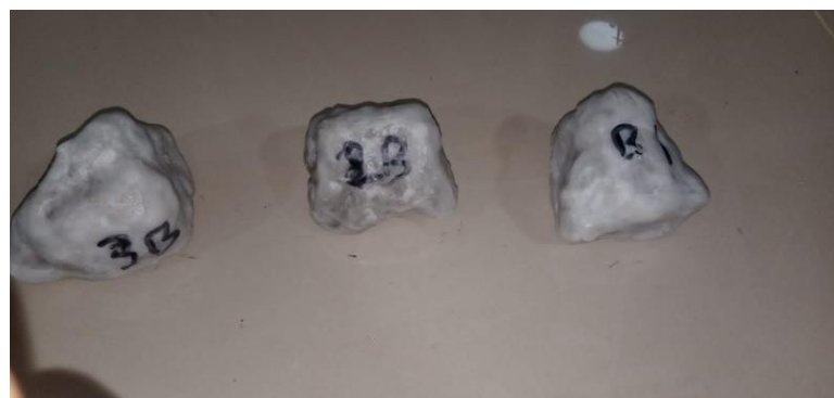
Figura 52 Muestra envuelta con la parafina para ensayo volumétrico
