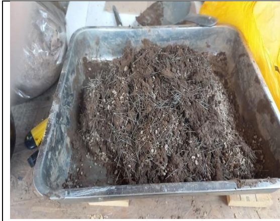
Figura 18 Suelo natural reforzado con 1% de fibras sintéticas recicladas de 3cm
