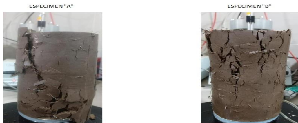
Figura 73 Rotura de probeta A y B muestra con 0.5% fibras sintéticas de 3cm
