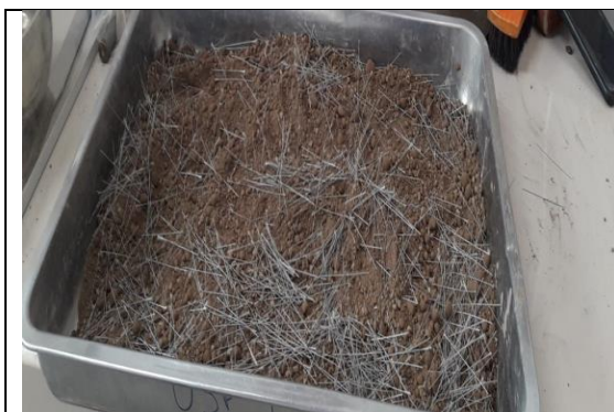
Figura 16 Suelo natural reforzado con 0.5% de fibras sintéticas recicladas de 6cm
