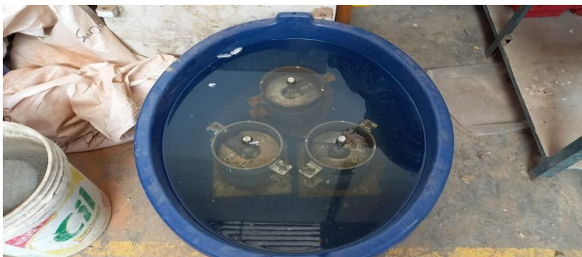
Figura 78 Suelo patrón con 1% fibras sintéticas 3cm longitud periodo de inmersión 96 horas
