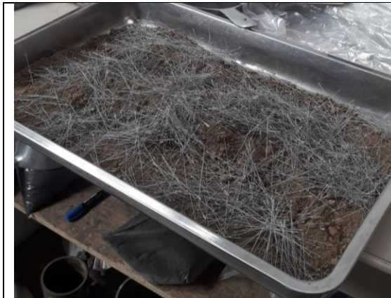
Figura 20 Suelo natural reforzado con 1% de fibras sintéticas recicladas de 6cm
