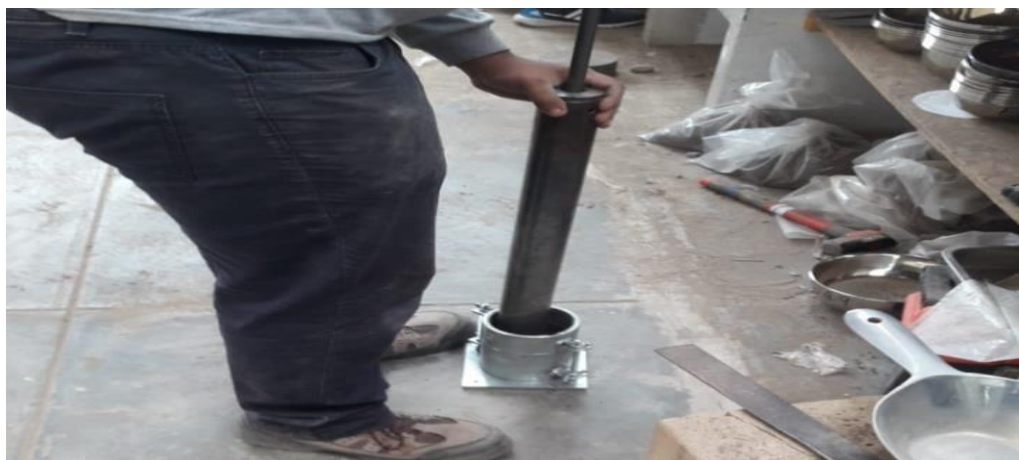
Figura 63 Compactación de la primera capa de la muestra con 0.5% fibras de longitud 6cm
