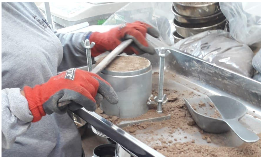
Figura 56 Enrasado del molde con regla metálica
