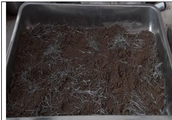
Figura 26 Suelo natural reforzado con 0.5% de fibras sintéticas recicladas de 3cm
