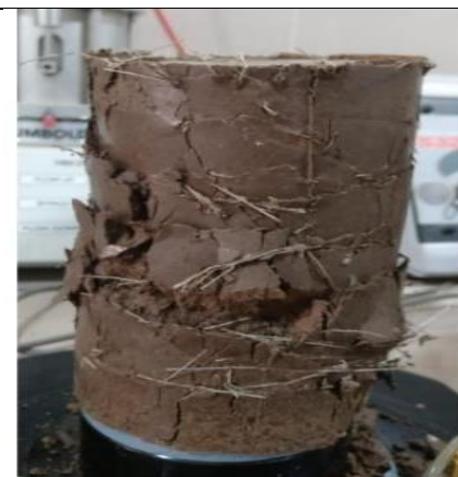
Figura 23 Rotura de probeta suelo natural reforzado con 1.5% de fibras sintéticas recicladas de 6cm
