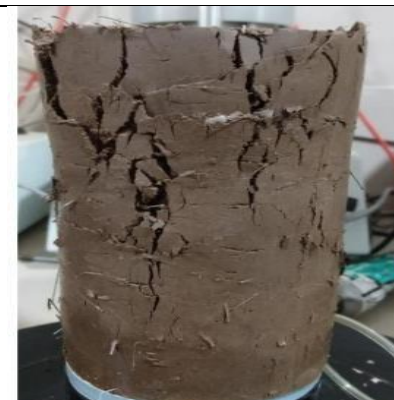
Figura 27 Rotura de probeta suelo natural reforzado con 0.5% de fibras sintéticas recicladas de 3cm
