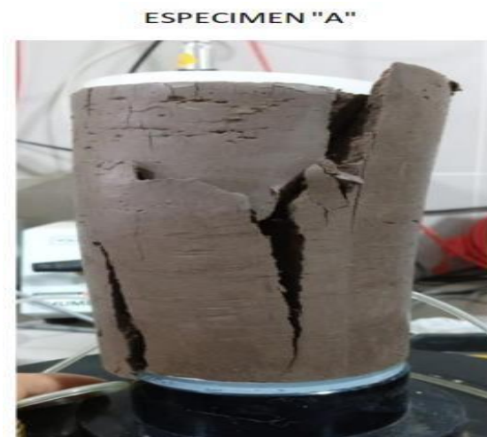
Figura 66 Rotura probeta A de muestra patrón
