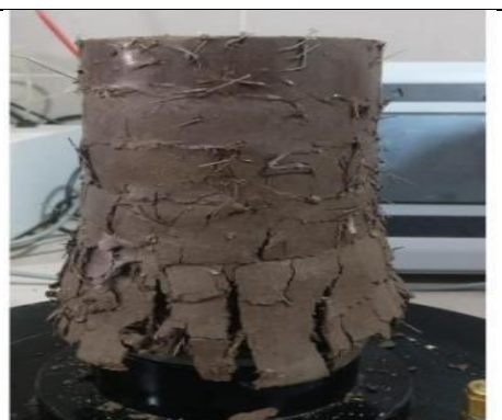
Figura 17 Rotura de probeta suelo natural reforzado con 0.5% de fibras sintéticas recicladas de 6cm
