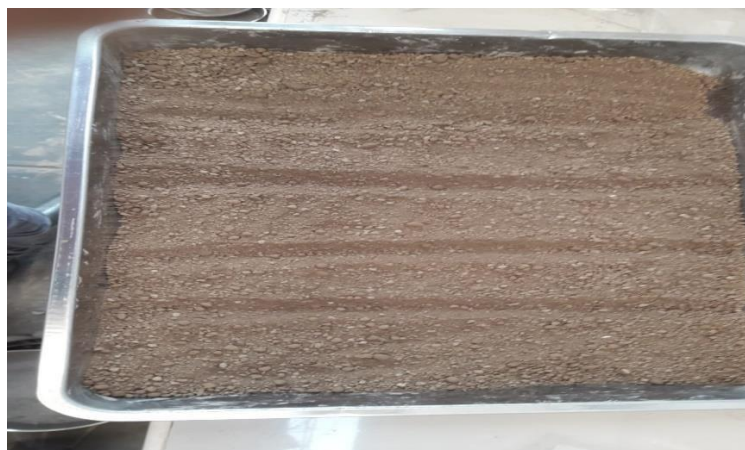
Figura 54 Preparación de la muestra para el ensayo de proctor modificado
