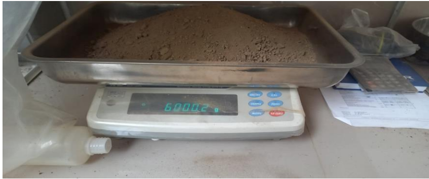
Figura 75 Pesado de muestra patrón para el ensayo CBR
