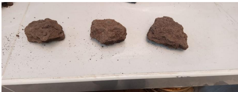
Figura 51 Preparación de muestra para el ensayo de peso volumétrico
