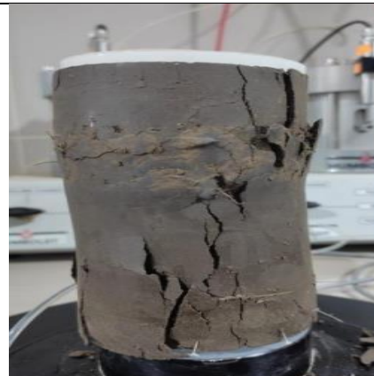
Figura 21 Rotura de probeta suelo natural reforzado con 1% de fibras sintéticas recicladas de 6cm
