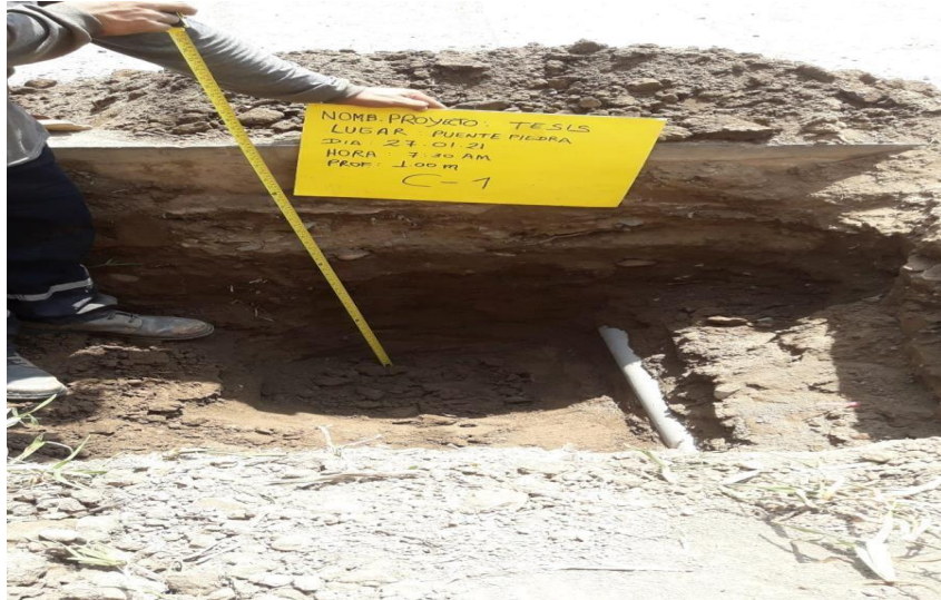
Figura 13 Extracción de muestra patrón para 1m de profundidad
