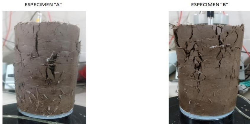
Figura 69 Rotura de probeta A y B muestra con 1.5% fibras sintéticas de 3 cm
