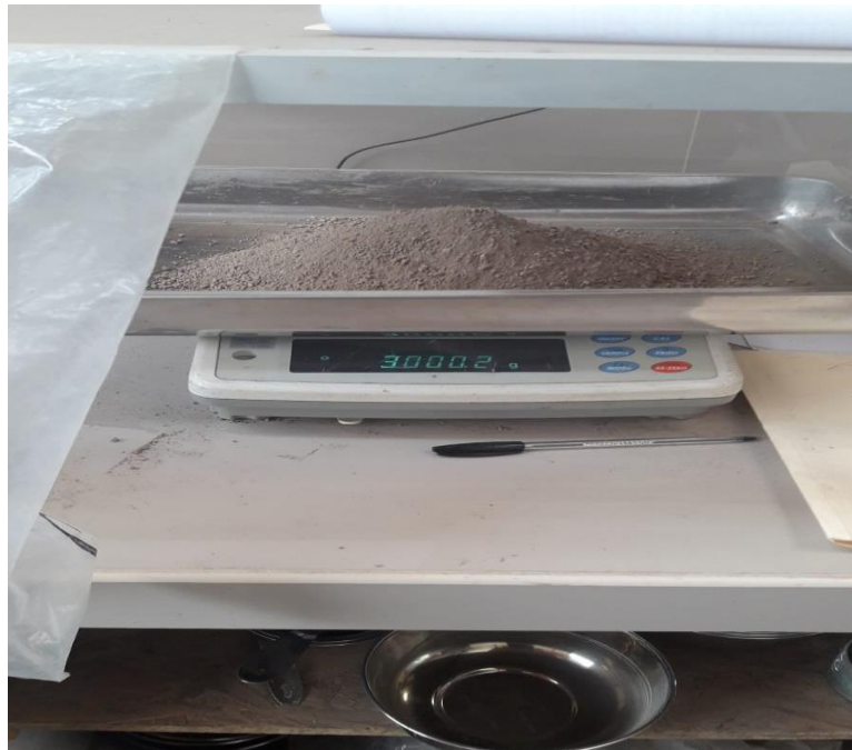
Figura 53 Peso de muestra patrón para ensayo de proctor modificado
