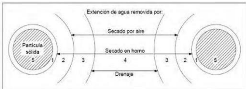
Figura 5 Representación de las zonas de agua en una partícula arcillosa (Carrillo, 2019)
