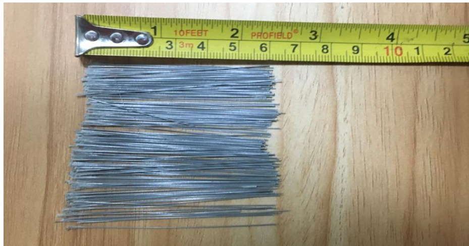
Figura 46 Fibras sintéticas recicladas (PET) de 6cm de longitud
