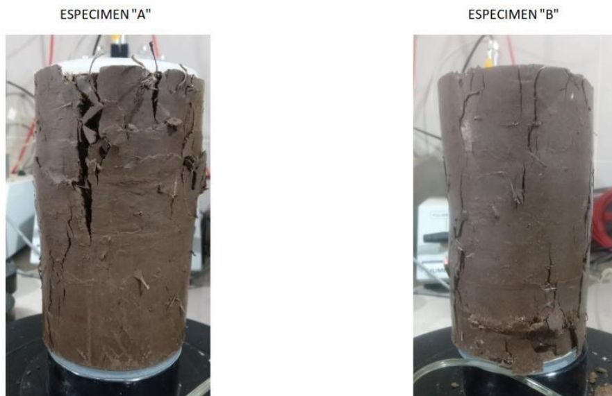
Figura 71 Rotura de probeta A y B muestra con 1% fibras sintéticas de 3cm
