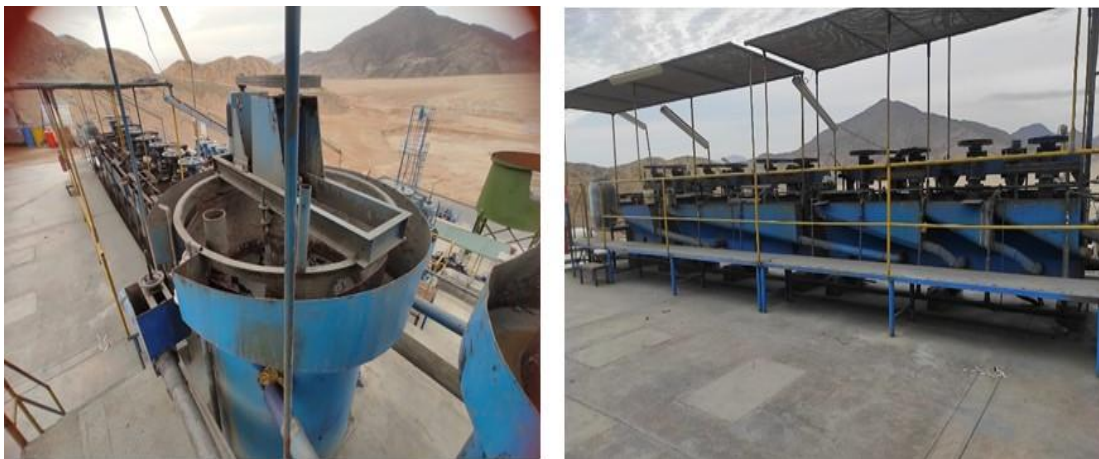
Figura 2.25. Circuito de flotación de plomo
