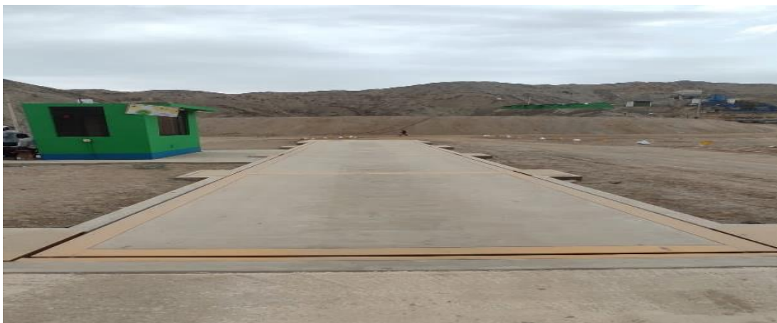
Figura 2.15. Balanza Electrónica de la Planta Concentradora Centenario
