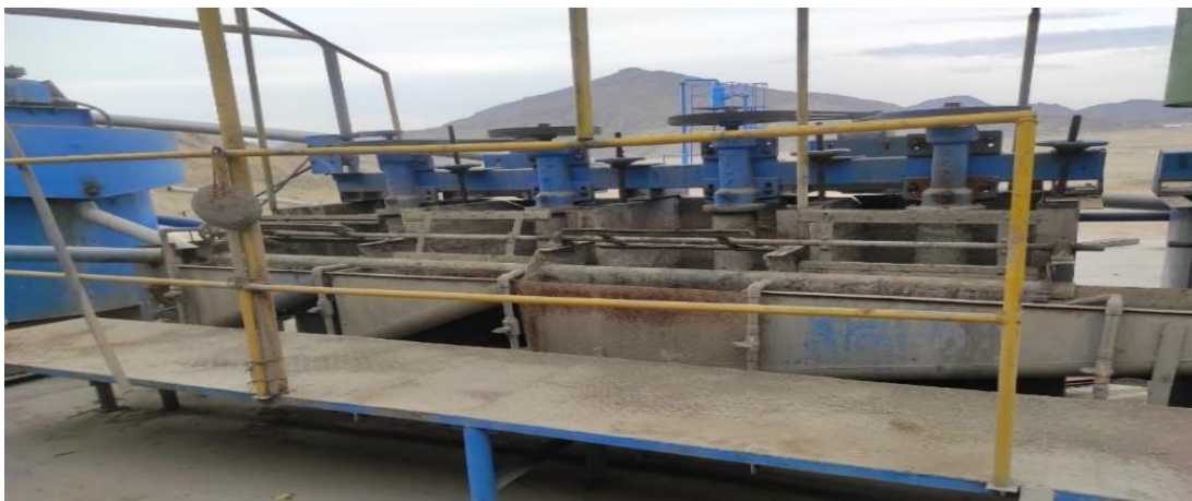
Figura 2.27. Circuito de flotación de zinc
