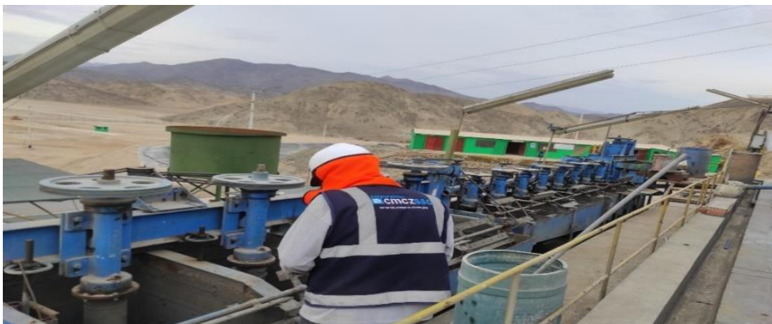
Figura 2.26. Circuito de flotación de cobre
