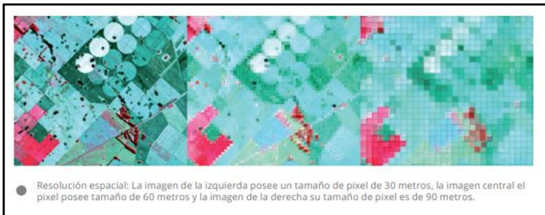
Figura N°07: Representación de tamaño de pixel de 30, 60 y 90 metros.
