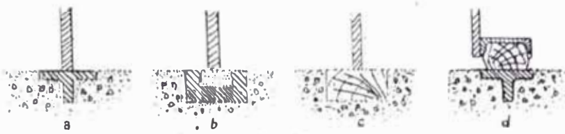
Impermeabilización de solera
