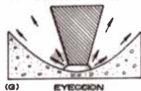
FIG. N°3 : MECANISMO DE FORMACION DEL CRATER DEBAJO DE LA ESTRUCTURA CORTANTE (DIENTE) DE LA BROCA.
