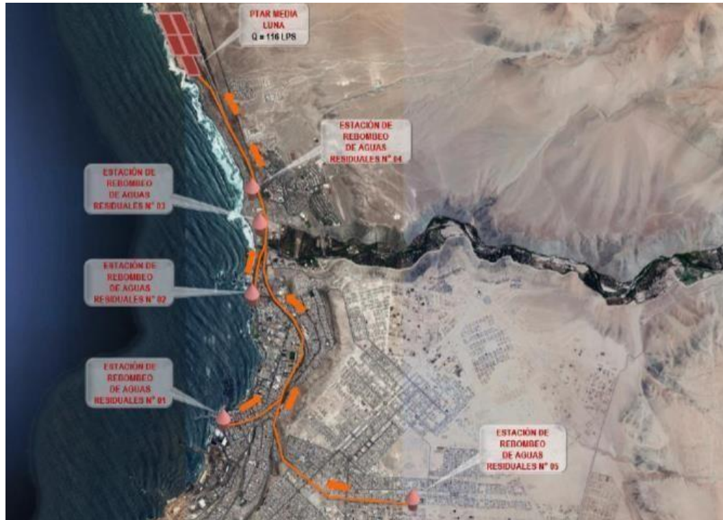
Figura N° 6: Esquema del Sistema de Alcantarillado
