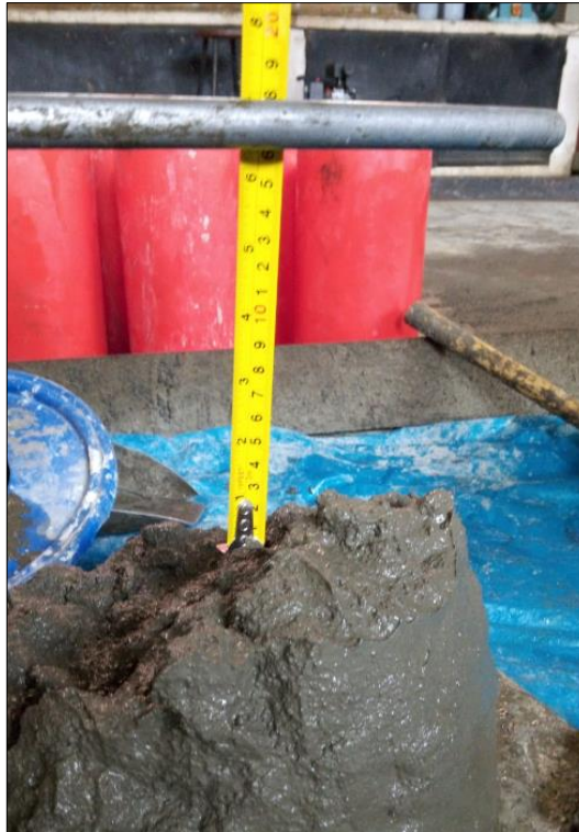
Figura N°12. Determinación del asentamiento
