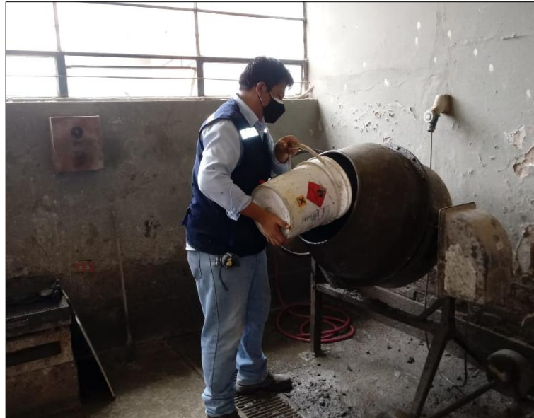
Figura N°20. Preparación en laboratorio de tanda de concreto con mezcladora
