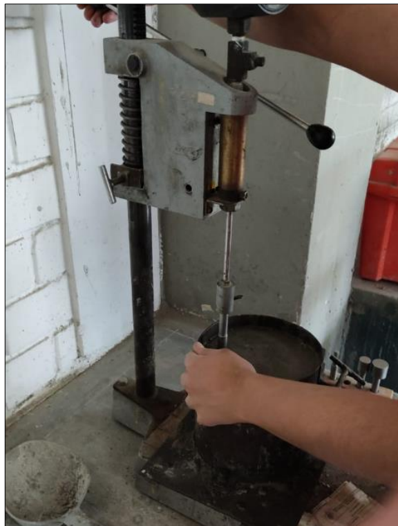
Figura N°21. Medición de la penetración para determinación de tiempo de fraguado
