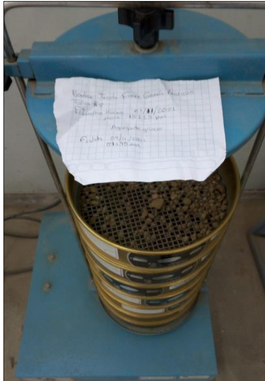
Figura N°06. Granulometría del agregado fino
