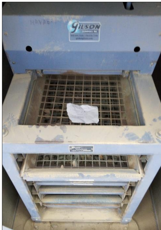
Figura N°06. Granulometría del agregado grueso
