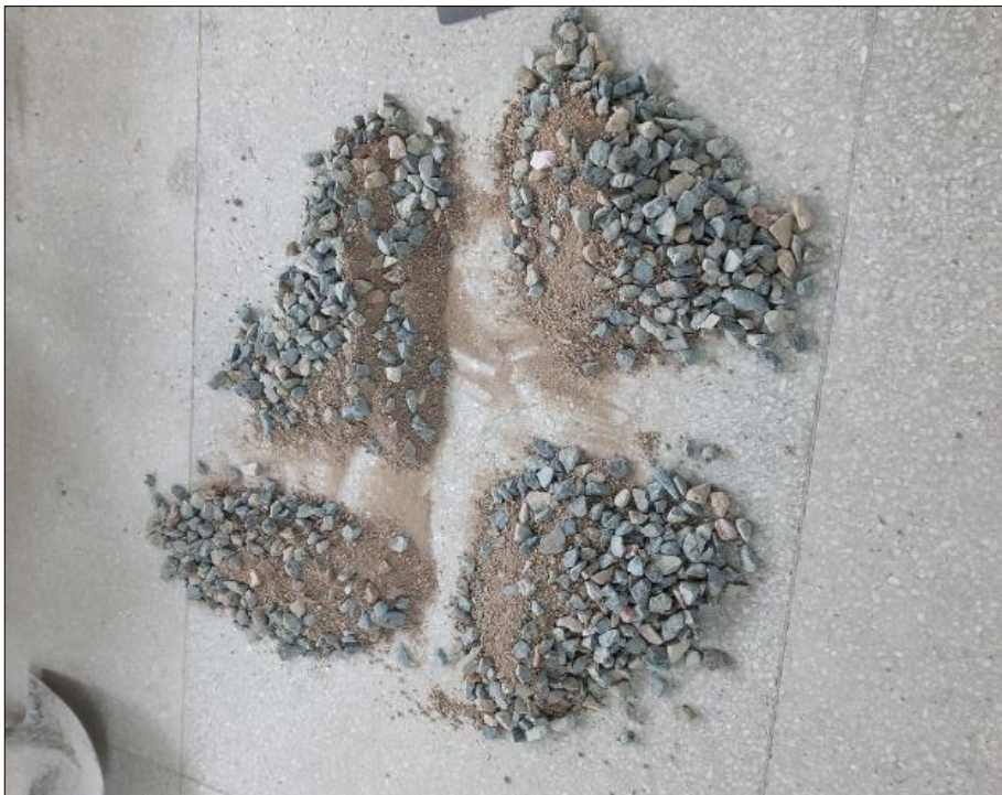
Figura N°02. Cuarteo de muestra para obtención de propiedades del agregado global.
