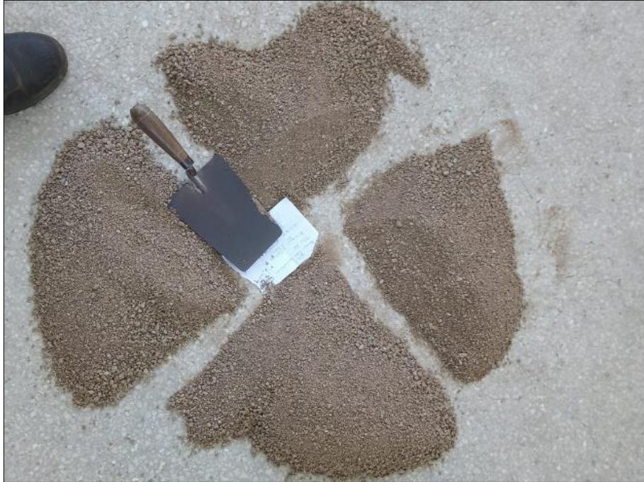
Figura N°01. Cuarteo de muestra para obtención de propiedades del agregado fino.
