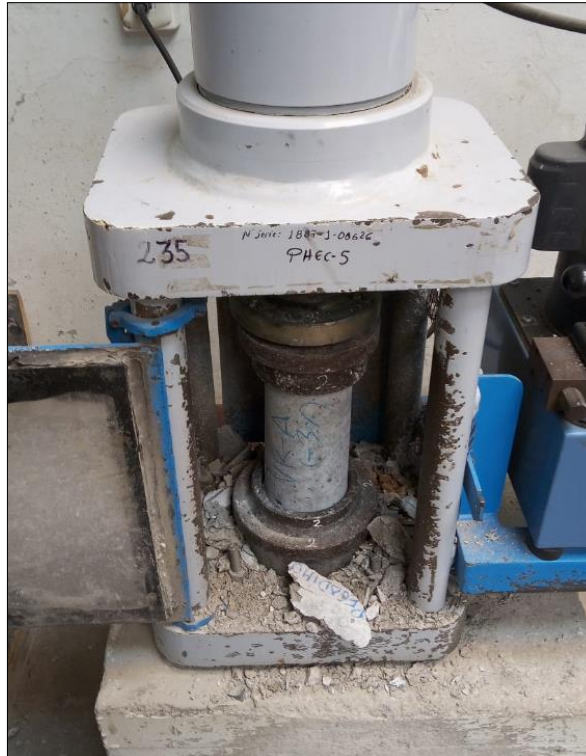
Figura N°10. Rotura de muestras para corrección de diseño por resistencia
