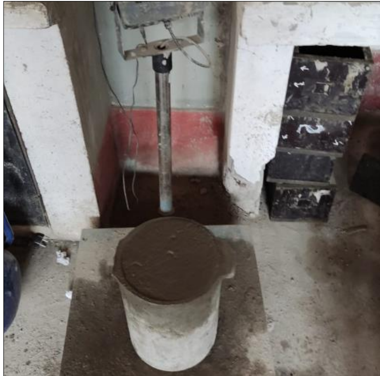
Figura N°24. Determinación del peso unitario del concreto en estado fresco
