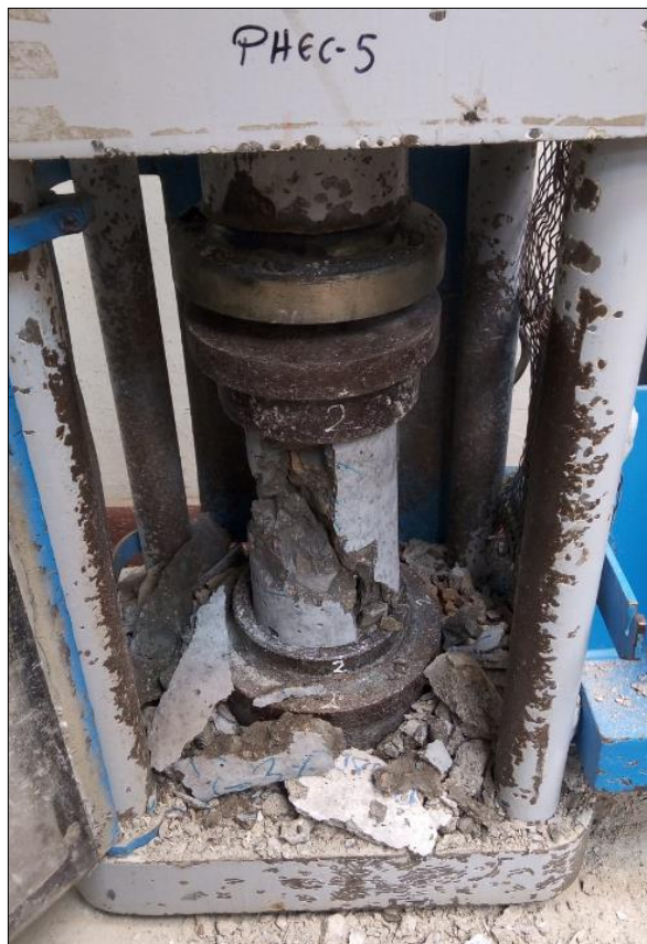
Figura N°11. Rotura de muestras para corrección de diseño por resistencia
