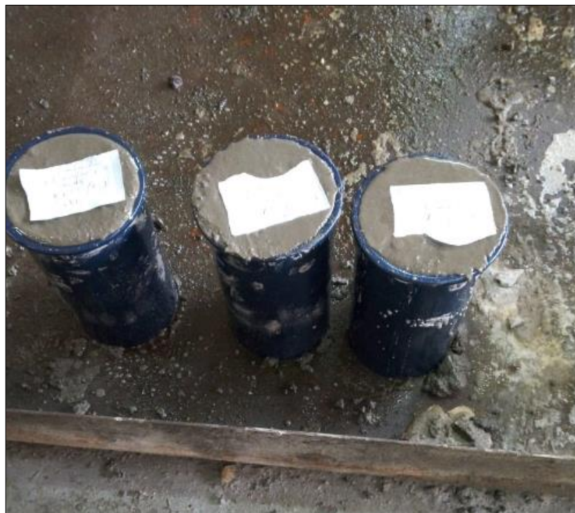
Figura N°09. Elaboración de muestras para corrección de diseño por resistencia
