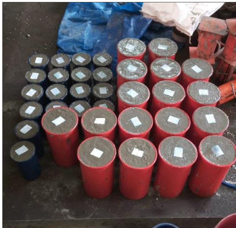
Figura N°13. Elaboración de muestras cilíndricas de 4"x8" y 6"x12"
