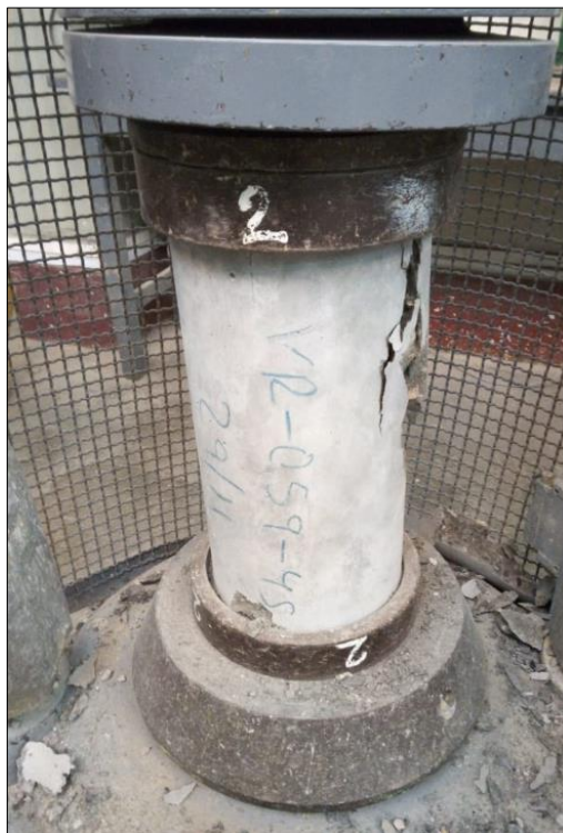
Figura N°19. Muestra cilíndrica de 6"x12" después de ensayo a compresión
