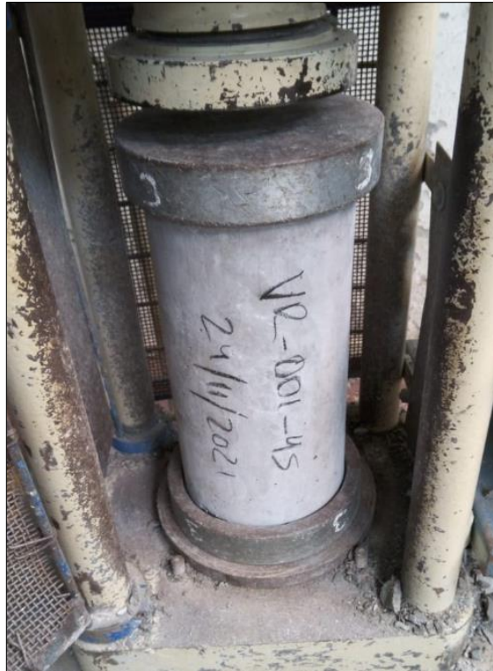
Figura N°16. Ingreso de muestras cilíndricas de 4"x8" a máquina de compresión
