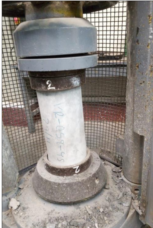
Figura N°18. Ingreso de muestras cilíndricas de 6"x12" a máquina de compresión
