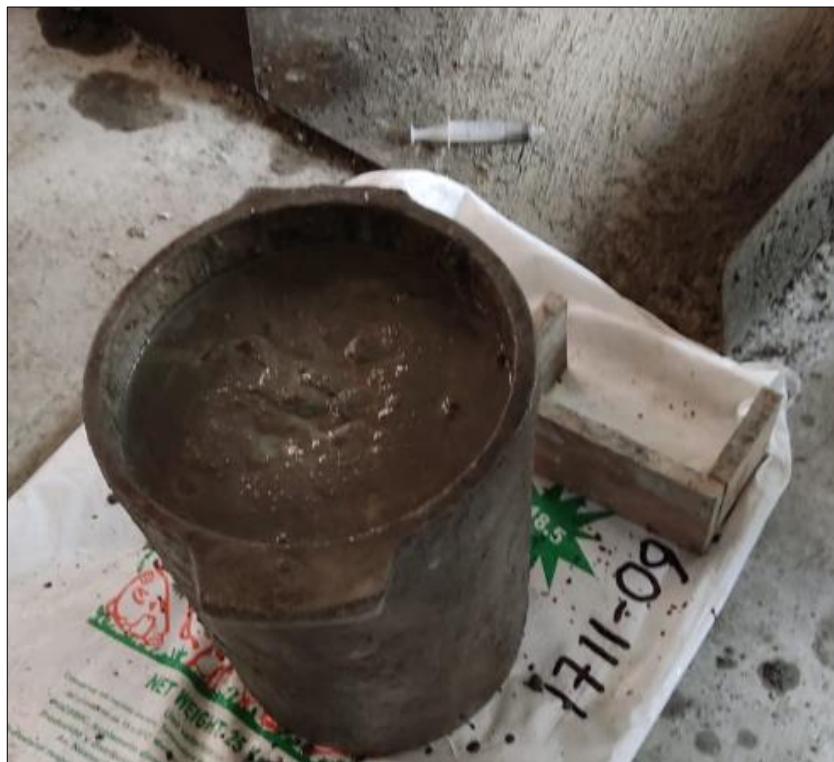
Figura N°23. Determinación de la exudación del concreto en estado fresco
