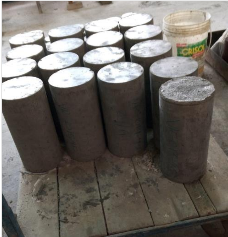
Figura N°14. Desencofrado de muestras cilíndricas para ingreso a poza de curado
