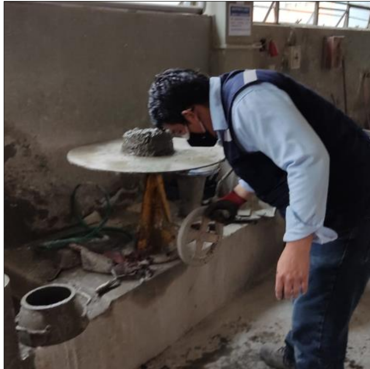
Figura N°22. Determinación del índice de fluidez
