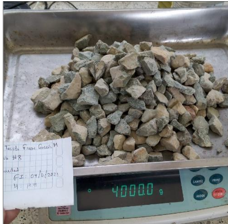
Figura N°08. Determinación de la humedad del agregado grueso
