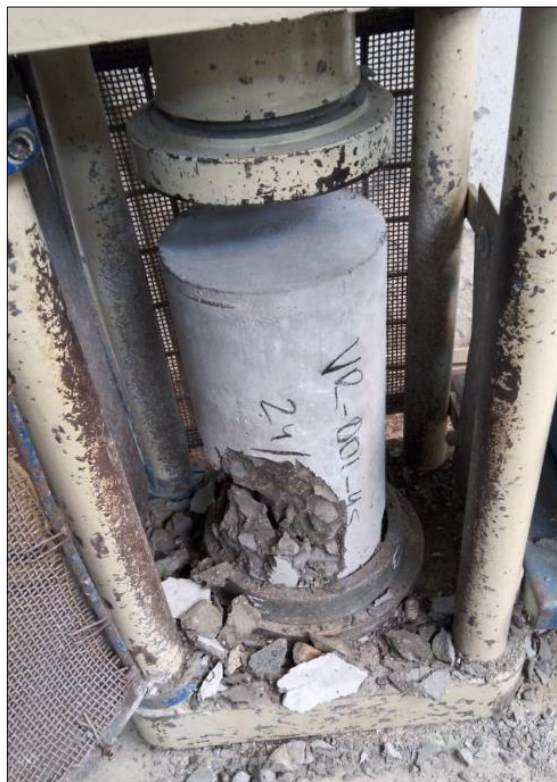
Figura N°17. Muestra cilíndrica de 4"x8" después de ensayo a compresión
