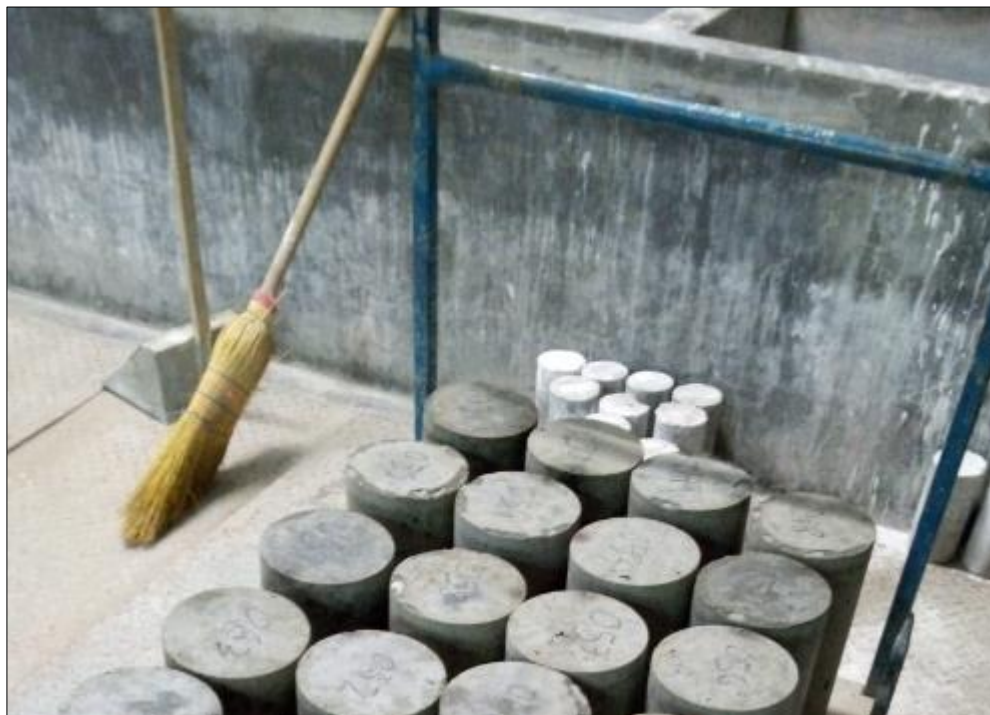
Figura N°15. Ingreso de muestras cilíndricas a poza de curado
