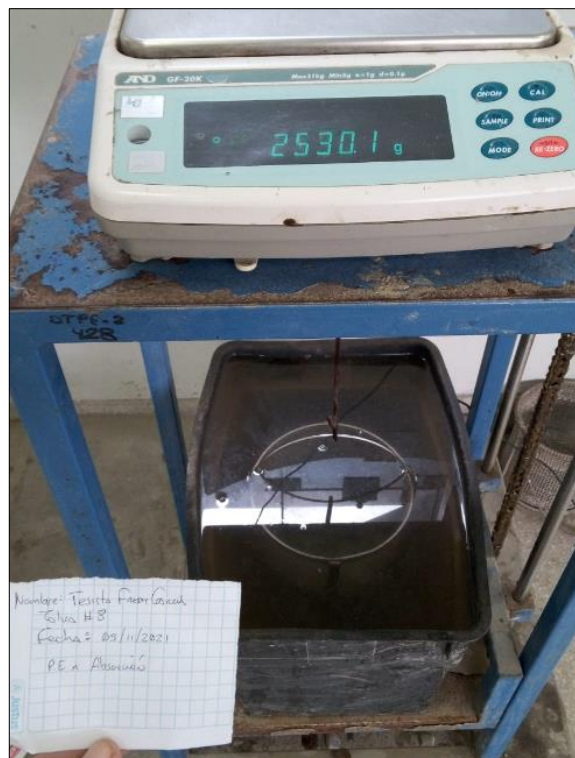
Figura N°08. Determinación del peso específico del agregado grueso
