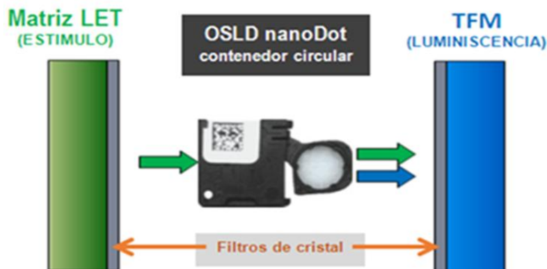
Figura 3.3: Esquema del proceso de lectura del \text{Al}_2\text{O}_3: \text{C} OSLD nanoDot [Jursinic (2007)].
