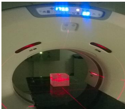
Figura 3.10: Montaje realizado para adquirir las imágenes en el STC del maniquí de Acrílico.
