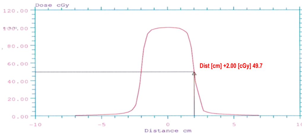
Figura 3.18b: Perfil de la curva de isodosis obtenida en el TPS Xio con el punto prescrito (+2.0 cm) y D_A local (49.7 cGy) a evaluar, con técnica SAD, campo de 6.0 x 4.0 cm 2 , profundidad 5.0 cm, energía fotones de 6.0 MV, gantry, colimador, y mesa a: 0.0°, para la región positiva \delta_2 , en la penumbra del haz de radiación.
