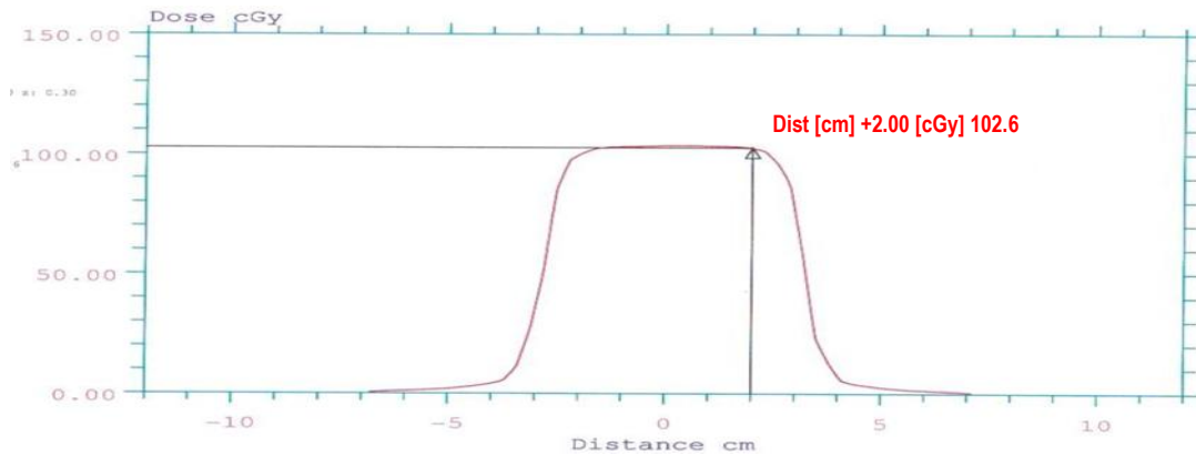
Figura 3.59b: Perfil de la curva de isodosis obtenida en el TPS Xio con el punto prescrito (+2.00 cm), y D_A local (102.6 cGy) a evaluar, con técnica SAD, campo 6.0 x 6.0 cm 2 , profundidad: 7.6, 7.8, 7.7, 7.7, 7.8, y 7.60 cm, energía fotones de 6.0 MV, gantry, en ángulos: 25.0°, 65.0°, 115.0°, 245.0°, 295.0°, y 335.0°, colimador, y mesa a 0.0° para región positiva \delta_3 , dentro del campo – fuera del eje del haz.
