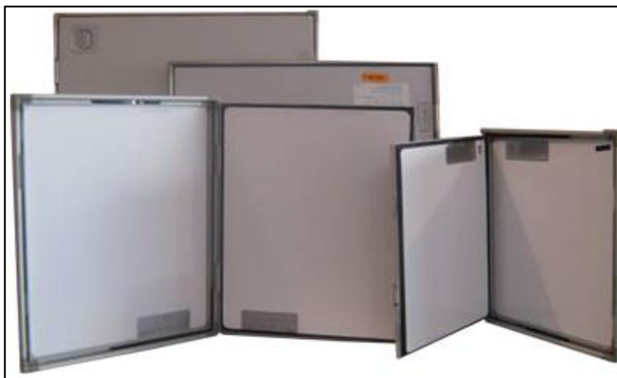
Fig. 19. Chasis de diferentes tamaños mostrando sus pantallas intensificadoras. [19]
