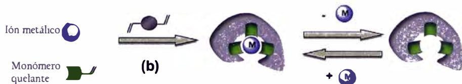
Figura 6. Representación esquemática de la síntesis de IIPs empleando un agente quelante vinilado. Adaptado (Branger et al. , 2013)
