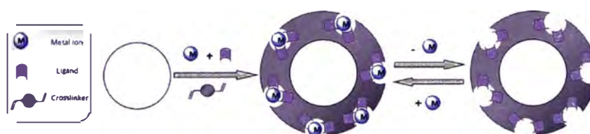
Figura 10. Técnica de impresión del MIP en la superficie (Fu et al. , 2015)
