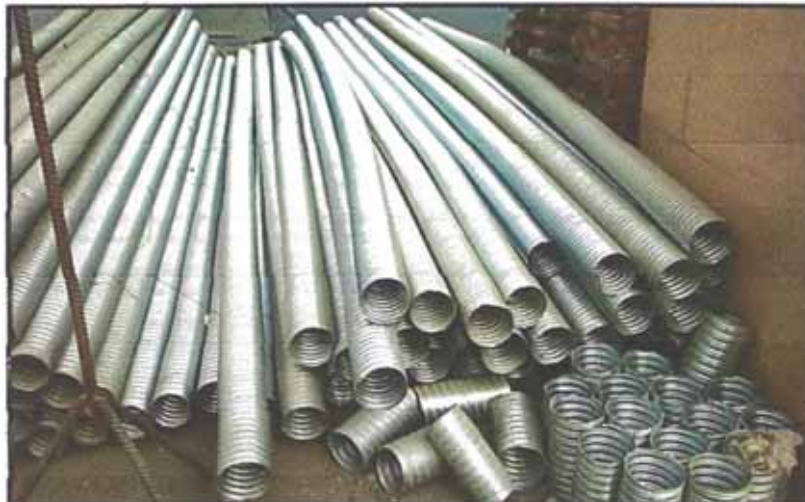
Figura N°5.77: Ducto de postensado
