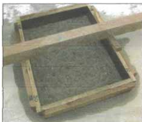
Figura N° 5.35d. Encofrado (Fuente: Propia).
