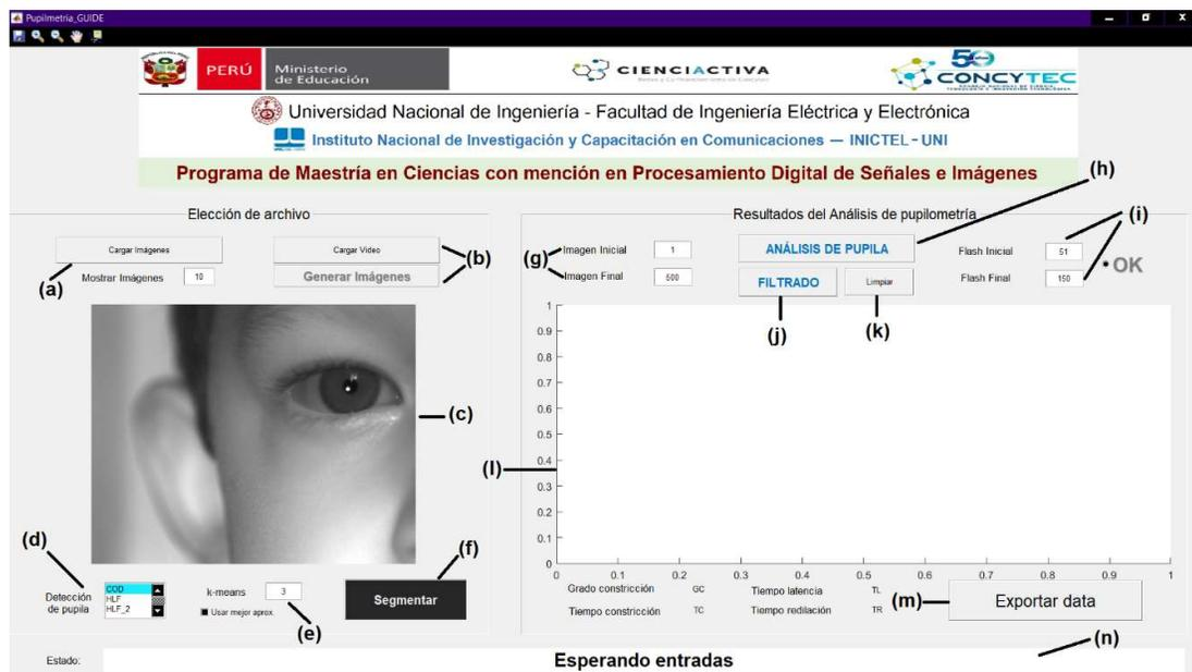
Figura 3.35. GUIDE de detección de pupila y adquisición de parámetros. Está dividido en dos paneles: a la izquierda, el panel para analizar imágenes; a la derecha, el panel que permite obtener las respuestas pupilares.
