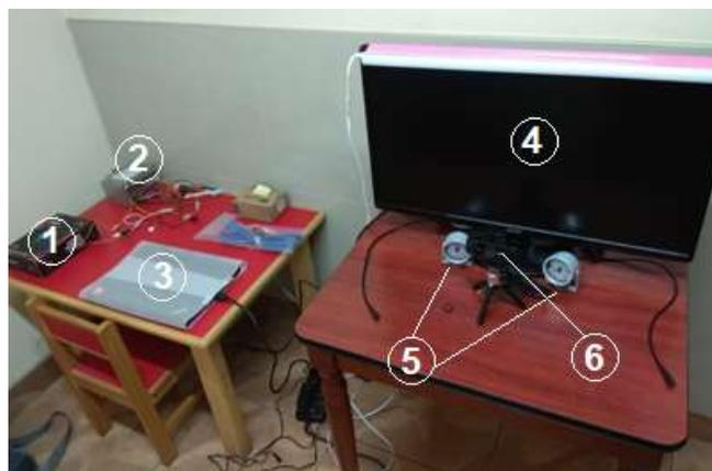
Figura 3.11. Configuración de ambiente en EOS. 1) Circuito de control. 2) Fuente de circuito. 3) Laptop. 4) Monitor. 5) Focos infrarrojos. 6) Cámara Logitech® referencial.
