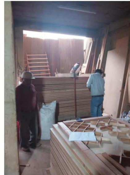
Se comienza con el cepillado de cara y canto de la madera usando maquina eléctrica (garlopa). Luego se procede a cortar al tamaño según las medidas necesarias de acuerdo con el plano de obra, usando una maquina eléctrica (engleteadora). Una vez q las maderas se encuentran preparadas se procede a realizar los cortes y contra cortes para darle forma al marco según detalles de los planos.
