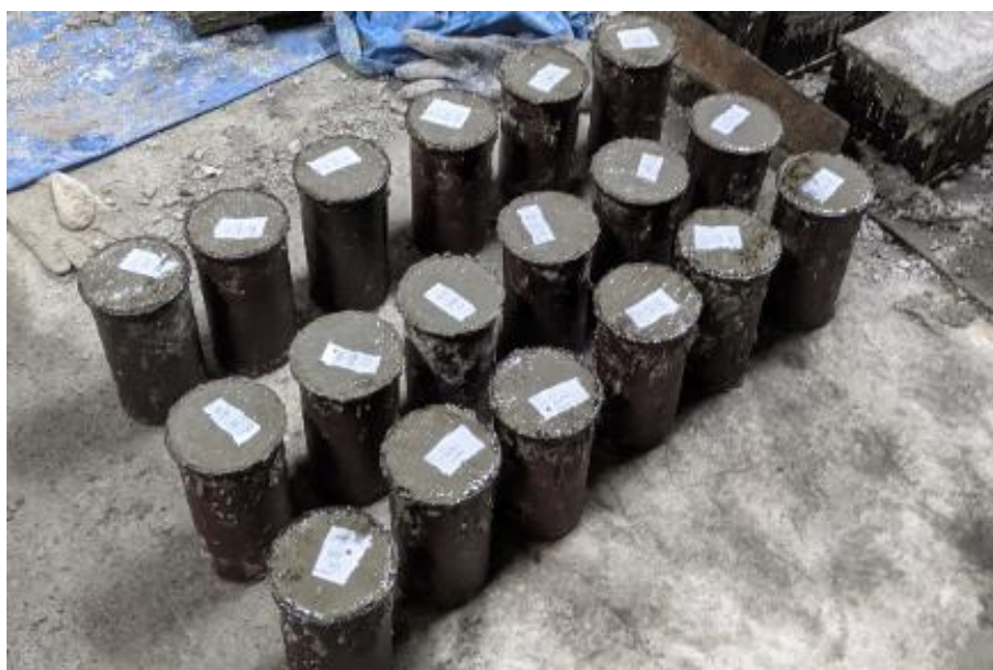
Anexo 186. Vaciado de concreto en probetas y etiquetado de las mismas
