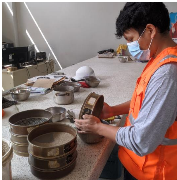
Anexo 182. Ensayo de granulometría del agregado fino: Extracción de muestra por tamiz para pesar.
