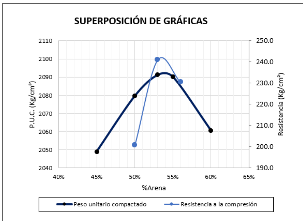
Anexo 46. Resistencia a la compresión a distintos porcentajes de agregado, usando cemento tipo ICo, a/c=0.5, agua = 205L
