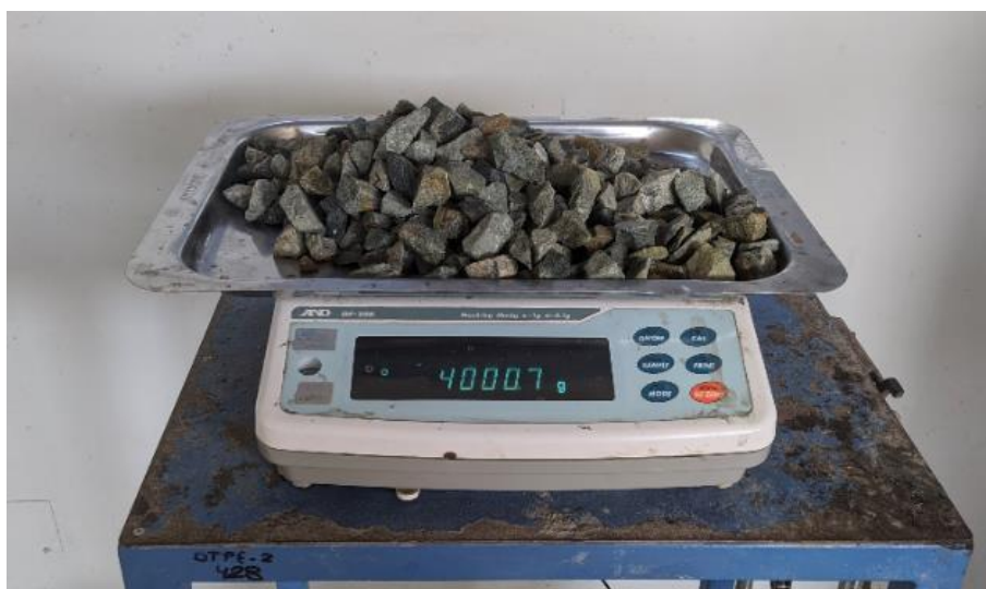
Anexo 180. Pesado de muestra para ensayo de peso específico y absorción del agregado grueso
