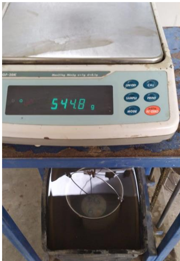
Anexo 197. Ensayo de absorción y vacíos: peso sumergido aparente
