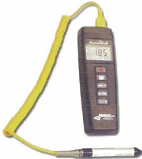
Figura 2.11 Pirómetro
