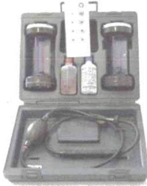
Figura 2.10 Aparato ORSAT para Análisis de Gases de Combustión
