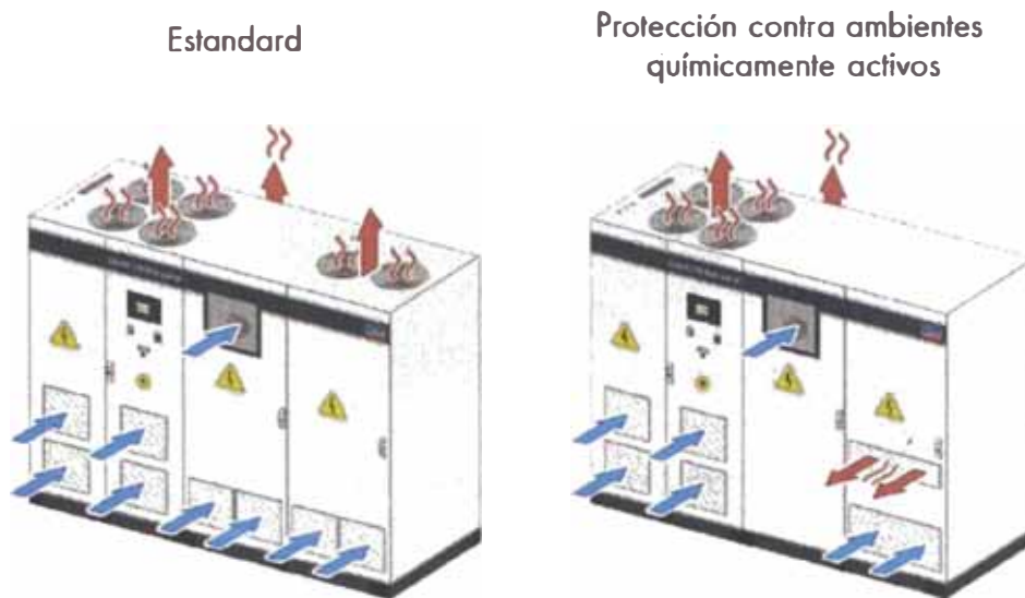
Figura 4.36 Sistema de Ventilación del Inversor Solar
