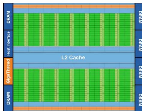
**Figura 1.30** Arquitectura de una GPU NVIDIA GeForce GTX 480
