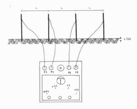
El equipo empleado para la medición de la resistividad del terreno fue el siguiente :
