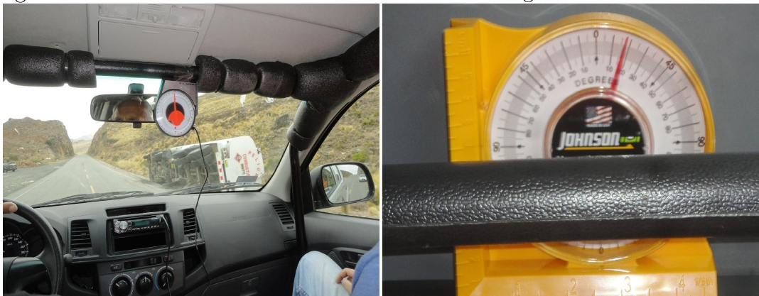
Figura 3.10: Medición con inclinómetro de la velocidad segura de recorrido en curvas.
