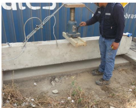
Foto 1: Precarga de Vigas con Gata Hidráulica. Se aplicó carga hasta descubrir primeras fisuras de tracción.
