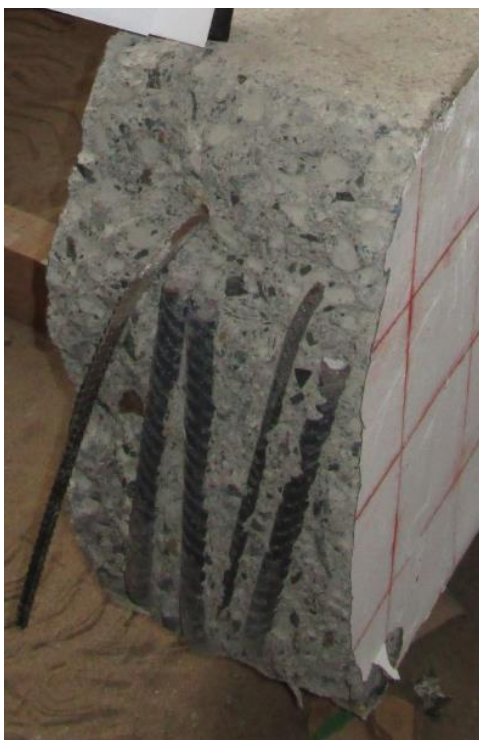
Foto 14: Detalle de Falla en el apoyo de VF-03.
