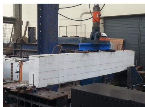
Foto 6: Viga montada en el soporte de acero, bajo configuración LDTV y Celda de Carga, conectados al sistema de Adquisición de datos.
