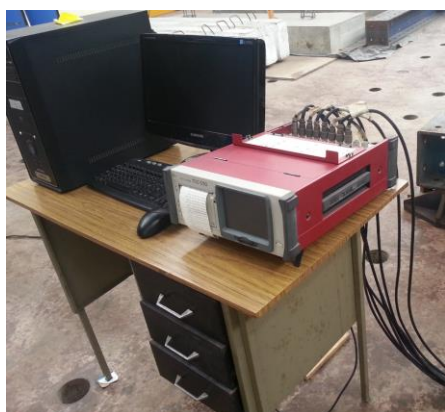
Foto 3: Sistema de Adquisición de Datos: Data Logger TDS-530 (incl. software) + Computador convencional.
