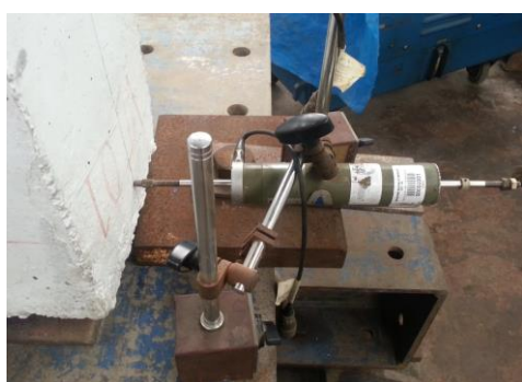
Foto 5: Sistema de medición: transductores tipo LDTV de 50 y 100 mm, de fabricación japonesa (Kiowa)
