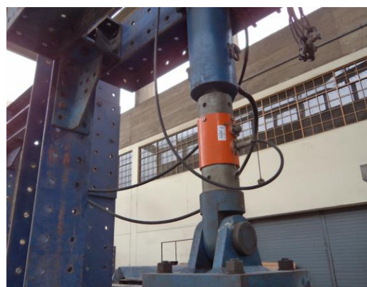
Foto 4: Celda de Carga: Gata + Bomba Hidráulica, de fabricación Japonesa (Yamamoto Kojyuki CO. Ltd)
