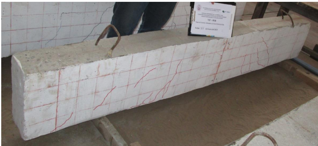
Foto 11: Elevación de Viga VF-01B, después del ensayo.
